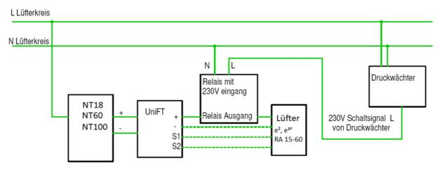
Vorschlag zur Verdrahtung zur sicheren Trennung der Lüfterspannungsversorgung (12 V) durch eine Sicherheitseinrichtung (hier Druckwächter). Die 230 V-Spannungsversorgung der Steuerung bleibt erhalten, alle Lüfter werden von der Spannungsversorgung getrennt.
