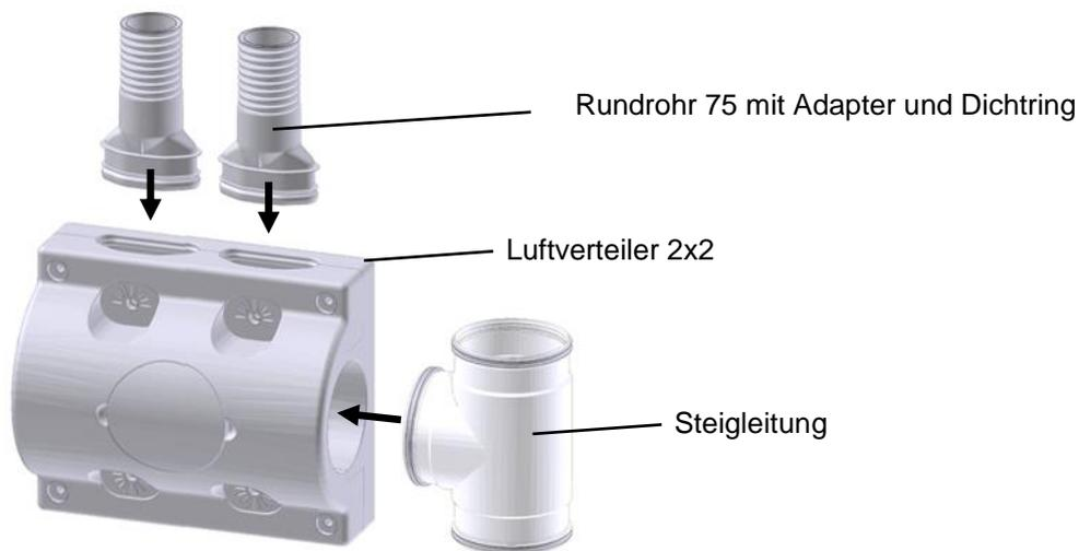
Abb. 23 Steigleitung und Rundrohr 75 anschließen
