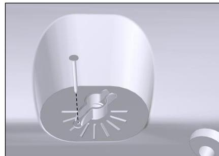
Abb. 24 Luftklappen einstellen und fixieren
