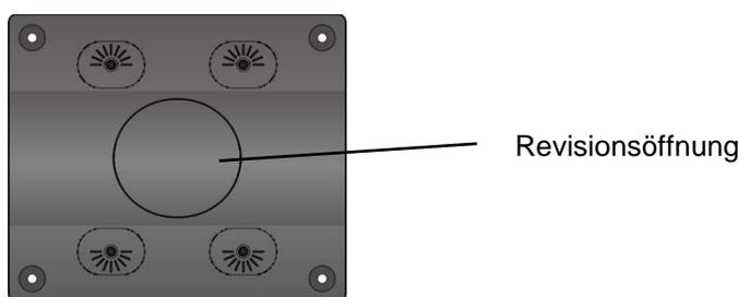
Abb. 27 Luftverteiler für Reinigung öffnen
