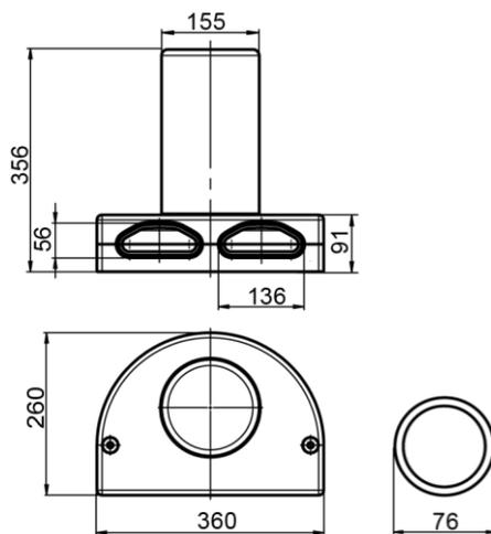
Abb. 4 Abmessungen Abluftelement/Zuluftelement und Rundrohr 75
