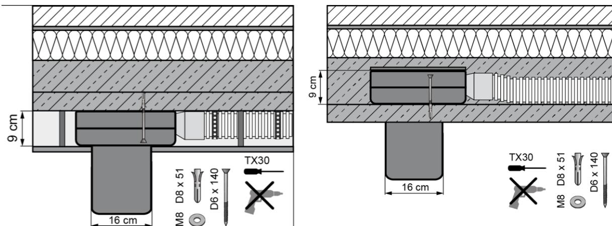
Abb. 15 Montage in abgehängter Decke und Rohbetondecke
