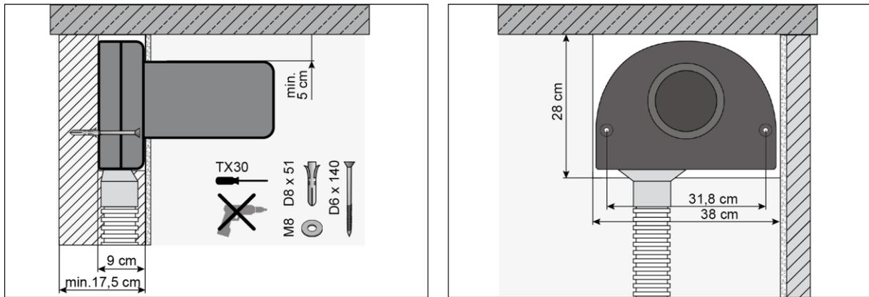
Abb. 16 Montage mit Schrauben und Dübeln (Massivbauwand), Seiten- und Frontansicht
