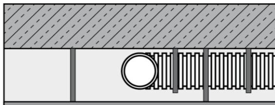
Abb. 10 Verlegung in einer abgehängten Decke
