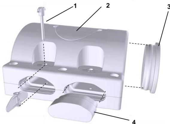
Abb. 21 Beispielhafte Montage Luftklappen, Verschlusskappen und Blindstopfen
