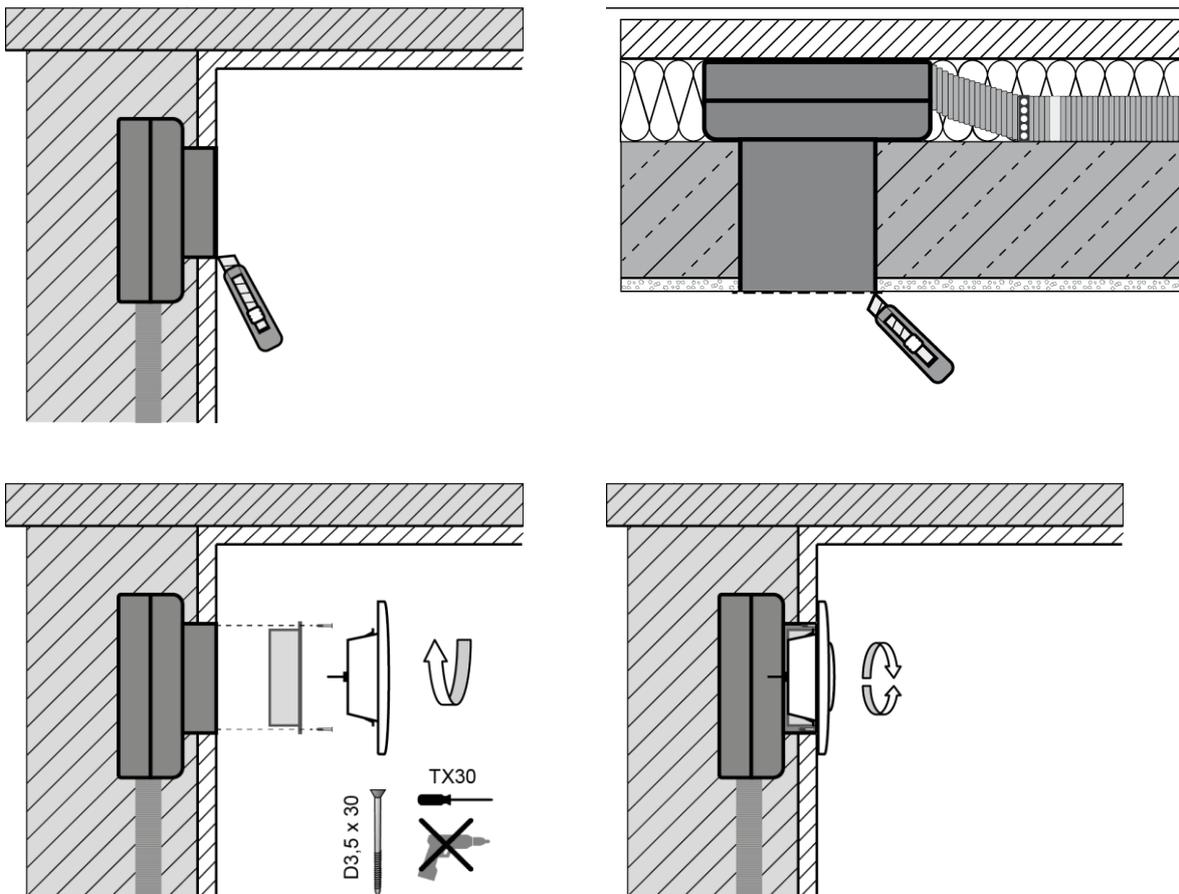
Abb. 18 Ablängen des Abluftelements und Montage Tellerventil
