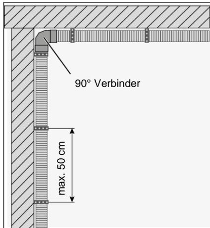
Abb. 12 Wand- und Deckenmontage von Rundrohren
