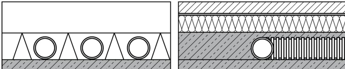
Abb. 8 Verlegung in der Rohbetondecke
