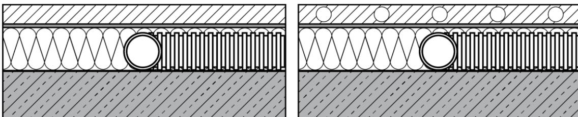
Abb. 9 Verlegung in der Dämmebene - ohne Fußbodenheizung (links), mit Fußbodenheizung (rechts)
