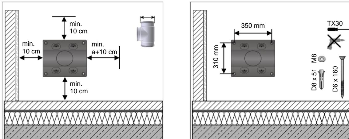
Abb. 22 Wandmontage Luftverteiler (links: Mindestabstände; rechts: Bohrungsabstände)
