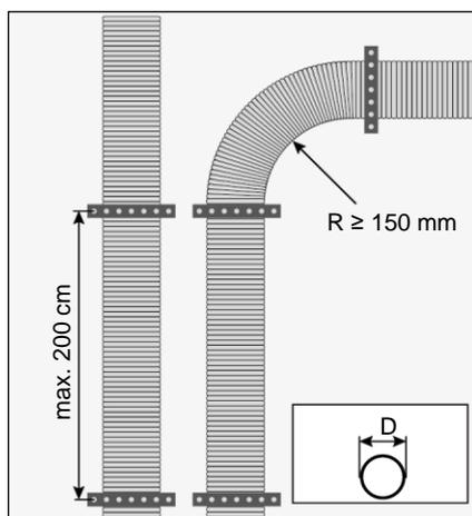
Abb. 11 Bodenmontage von Rundrohren
