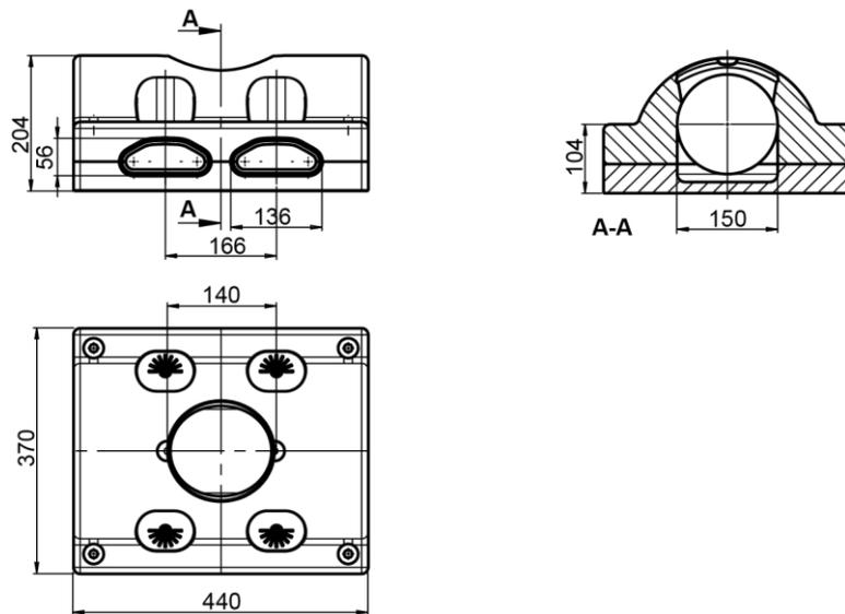
Abb. 3 Abmessungen Luftverteiler 2x2 (alle Maße in mm)
