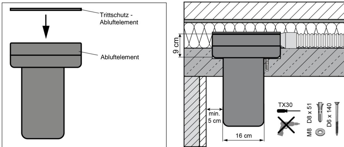
Abb. 14 Montage Abluftelement mit Trittschutz in der Dämmebene
