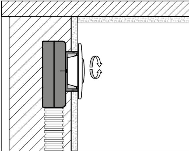
*Abb. 26 Einstellung des Tellerventils*
