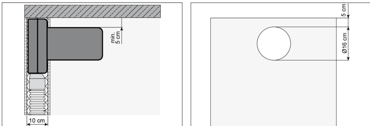
Abb. 17 Montage in Trockenbauwänden, Seiten- und Frontansicht
