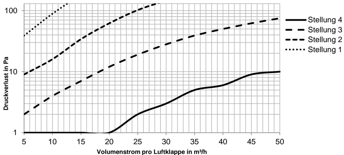
Abb. 25 Druckdifferenz durch Luftklappe
