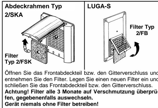
Öffnen Sie das Frontabdeckteil bzw. den Gitterverschluss und entnehmen Sie den Filter. Legen Sie einen neuen Filter ein und schließen Sie das Frontabdeckteil bzw. den Gitterverschluss.
