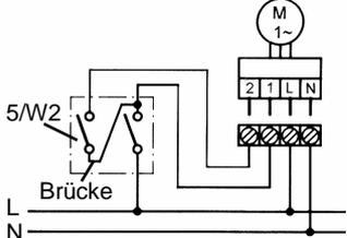
Dauerbetrieb Grundlüftung, zweistufiger Betrieb, schaltbar auf Bedarfslüftung und Volllast EIN/AUS.
