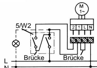
Zweistufiger Betrieb, schaltbar auf Bedarfslüftung und Volllast EIN/AUS.
