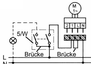
Einstufiger Betrieb, schaltbar auf Bedarfslüftung EIN/AUS.
