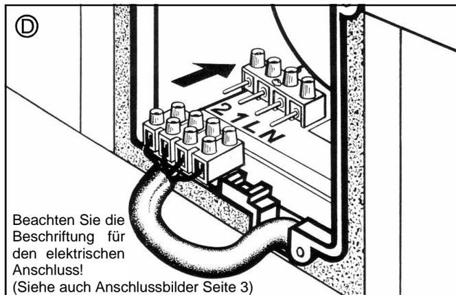
Schieben Sie den Lüftereinschub bis zum Anschlag ein, so dass sich die Ausblasöffnung unter dem Ausblasstutzen befindet!
