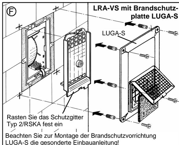
Befestigen Sie den Abdeckrahmen (einschließlich Frontabdeckteil und Filter) mit der Zentralschraube! Schließen Sie das Frontabdeckteil! Richten Sie den Abdeckrahmen aus! Die Wanddichtung muss dicht an der Wand sitzen!
