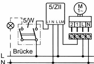
Dauerbetrieb Grundlüftung mit zeitnachlaufgesteuerter Bedarfslüftung. Weitere Anschlussmöglichkeiten siehe separate Einbauanleitung für den Zeitnachlauf 5/ZII.
