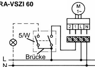
a) Dauerbetrieb Grundlüftung, einstufiger Betrieb auf Bedarfslüftung EIN/AUS
