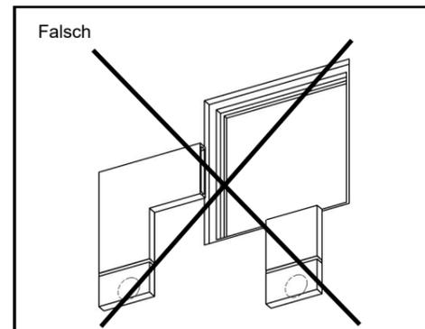
**Positionierung des Putzrahmens (Fassadenelement bei Montage in der Dämmung)**
