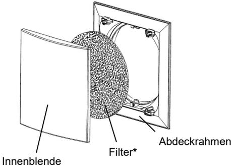
**\* Der Filter ist Bestandteil der Versandeinheit des Einschubs für das jeweilige Komplettgerät. Betreiben Sie das Lüftungsgerät nie ohne Filter.**
