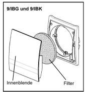
Rasten Sie nach dem Einlegen des Filters die Innenblende in Offenstellung ein. Die Zuluftöffnung darf nicht zugestellt oder verdeckt werden!
