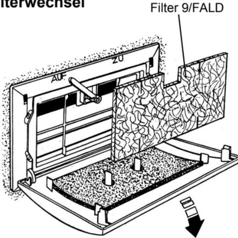
Wechseln Sie den Filter mind. alle 3 Monate bzw. bei erkennbarer Verschmutzung! Öffnen Sie den Innenverschluss und entnehmen Sie den Filter! Legen Sie einen neuen oder gereinigten Filter ein und schließen Sie den Innenverschluss.
