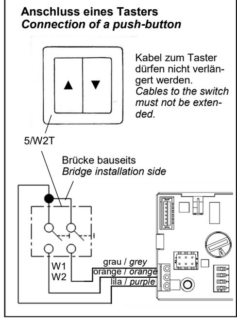
Werksseitig ist die 5/UNI-FT auf Schalterbetrieb eingestellt, die 5/UNI-RF auf Tasterbetrieb. By default, the 5/UNI-FT is set to the connection of a switch, the 5/UNI-RF of a push-button
