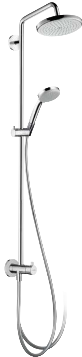
Croma® 220 Air 1jet Showerpipe Reno avec douche de tête pivotante Croma 220 Air 1jet (16 l/min), douchette à main Croma 100 Vario (15 l/min), sans mitigeur, bras de douche de 400 mm # 27224, -000 # 27158, -000 Kit de montage en angle (non représ.) Curseur réglable en hauteur
