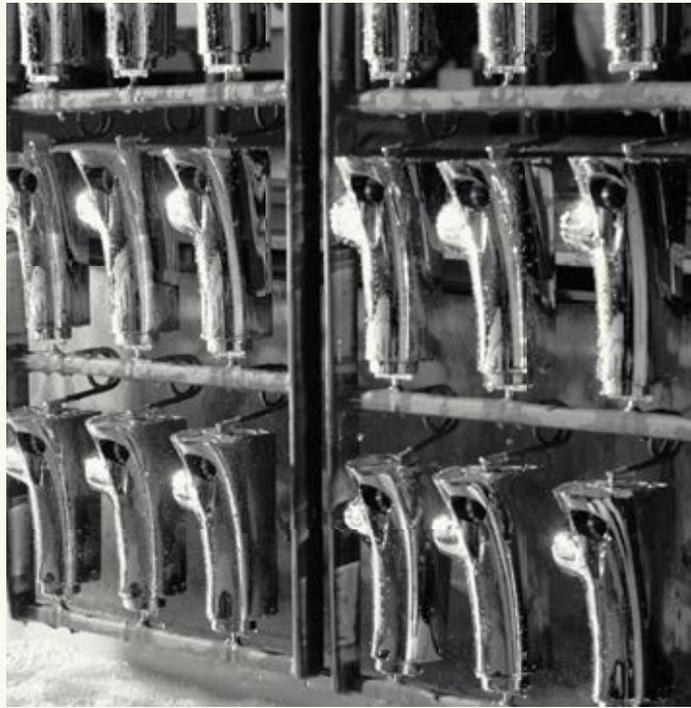
◀ La robinetterie est plongée dans un bain d'immersion électrolytique : le corps est encore en laiton. L'une des installations de galvanisation les plus modernes permet désormais de recouvrir la robinetterie Axor Massaud d'une couche de chrome d'une brillance intense qui lui confère résistance et longévité. Elle est, à cet effet, plongée dans différents bains galvaniques pendant une heure maximum.
