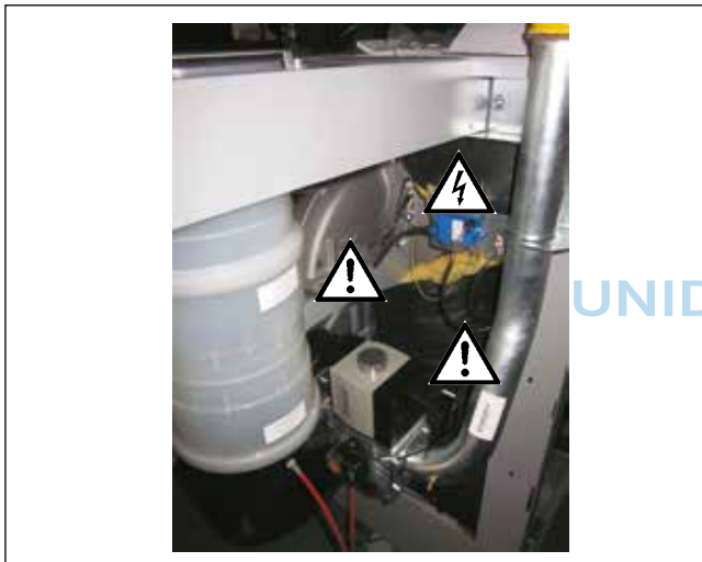
Bild: Zündtrafo, Hochspannungs-Zündelectrode, Gaskombiventil, Gasdruckwächter, Ventilator, Brennkammer Gefahr durch elektrische Spannung, Gefahr von Vergiftung und Explosion durch ausströmendes Gas, Gefahr von Verbrennung durch heiße Bauteile.
