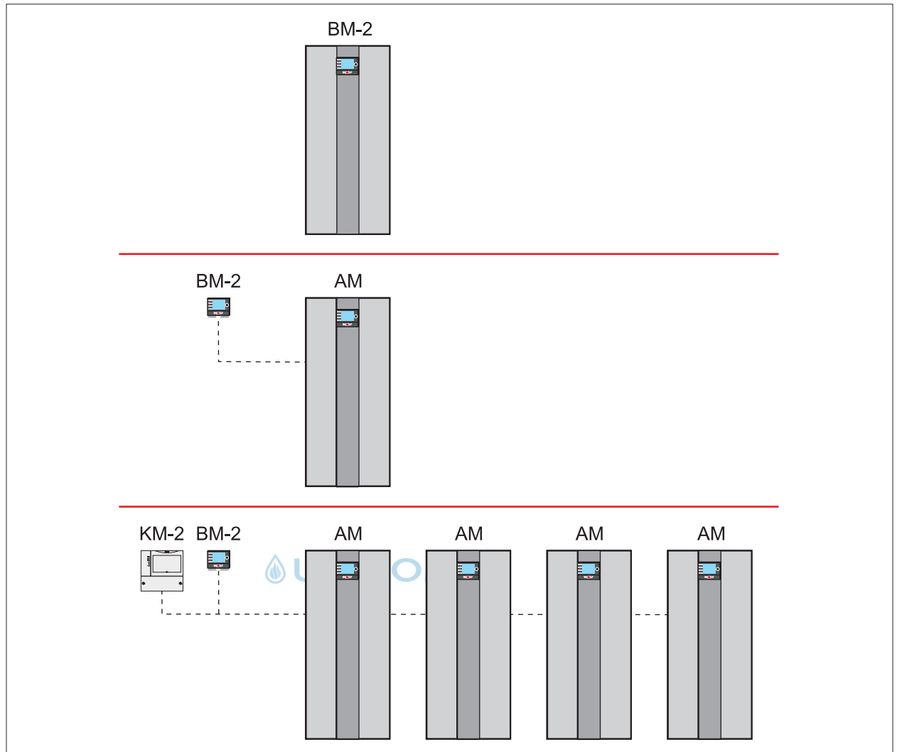
Abb. 5.26 Mögliche Steckplätze für Regelungsmodule
