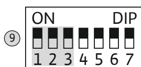
Fig. 19: DIP-Schalter 2: Überwachen der Betriebsparameter
