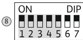
Fig. 9: DIP-Schalter 1: Motorstromüberwachung einstellen
