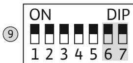
Fig. 10: DIP-Schalter 2: Pumpen aktivieren
