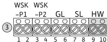
Fig. 13: Klemmleiste Sensorik: Hochwasser- alarm
