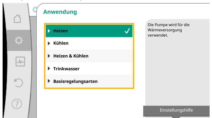
Fig. 46: Beispiel Anwendung „Heizen“
