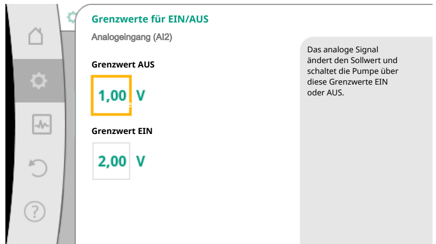
Fig. 74: Grenzwerte zur EIN/AUS-Steuerung über Analogsignale
