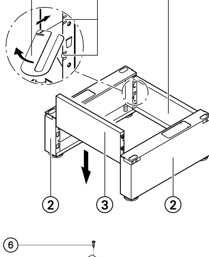
2. Seitenbleche (3) bis zum Anschlag in die Rahmenteile (2) einstecken.
