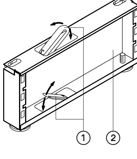
1. Vier Montageschlüssel (1) (werden später als Unterlegscheiben benötigt) aus Rahmenteilen (2) entfernen.
