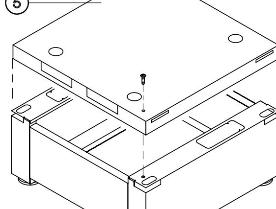
4. Abdeckblech (5) über das Untergestell stecken und mit Blechschrauben 3,9 x 9,5 (6) befestigen.
