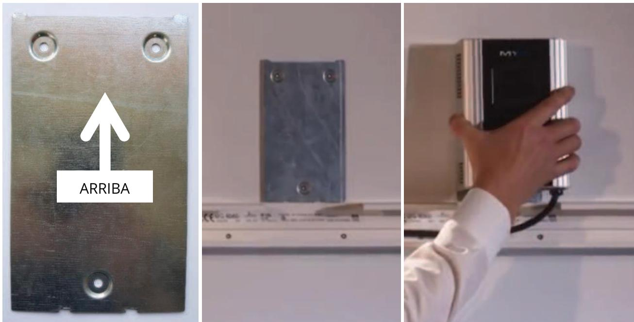
Para fijar el AC•THOR al soporte mural, cuélguelo en el soporte mural con los dos agujeros ranurados de la parte superior y luego fíjelo a la parte inferior con el cierre (deslícelo hacia la izquierda).
