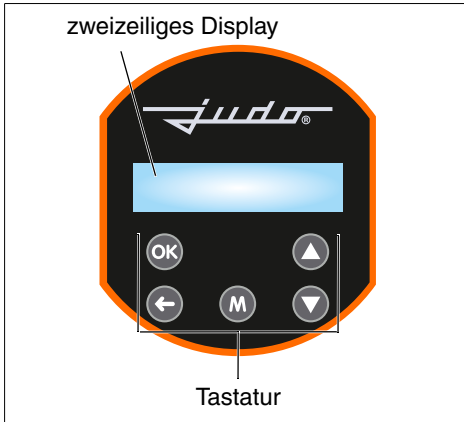
Abb. 11: Bedienfeld der Enthärtungsanlage
