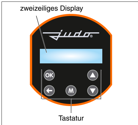
Abb. 11: Bedienfeld der Enthärtungsanlage
