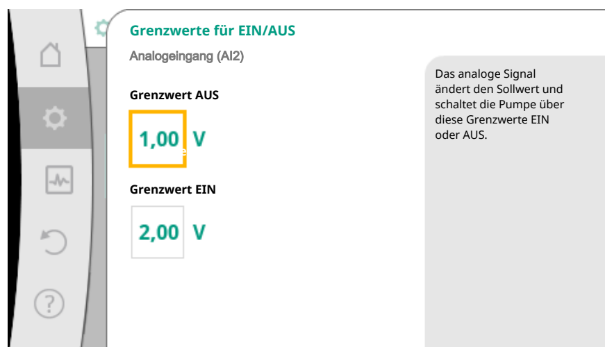
Fig. 74: Grenzwerte zur EIN/AUS-Steuerung über Analogsignale
