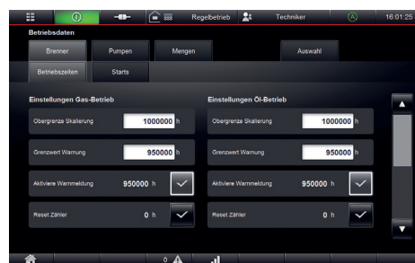
Predictive Maintenance (Beispiel Schaltzähler)
