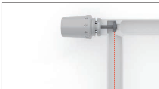
Heizkörperventil schließt durch Temperaturerhöhung
