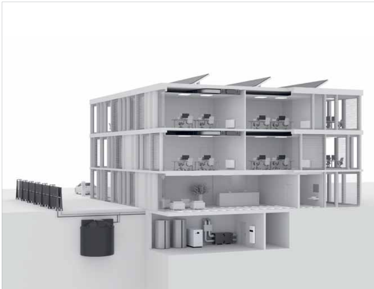
Vitocal 350-G PRO Sole/Wasser-Wärmepumpe mit Eis-Energiespeicher
