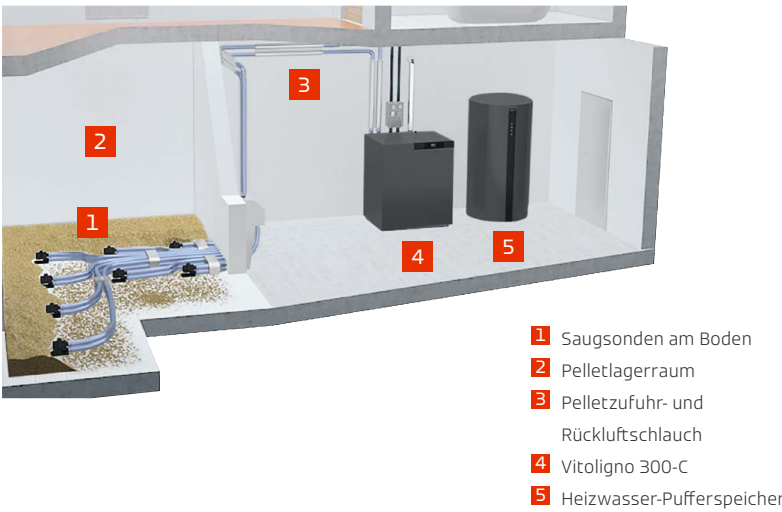
Lagerraum ohne Schrägboden mit Zuführung zum Pelletkessel über Saugsonden
