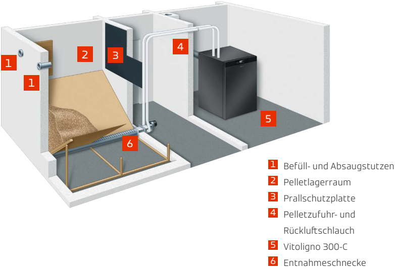
Pelletsilo (Gewebetank) mit Zuführung zum Pelletkessel durch Vakuum-Saugsystem
