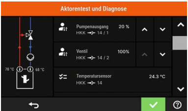
Ecotronic Touch - Anzeige Aktorentest und Diagnose
