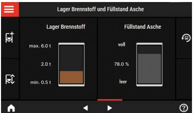
Ecotronic Touch - Anzeige Brennstofflager und Aschefüllstand
