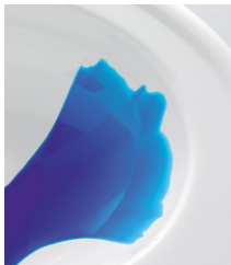
Abflussverhalten von Flüssigkeiten auf einer herkömmlichen Keramikoberfläche.
