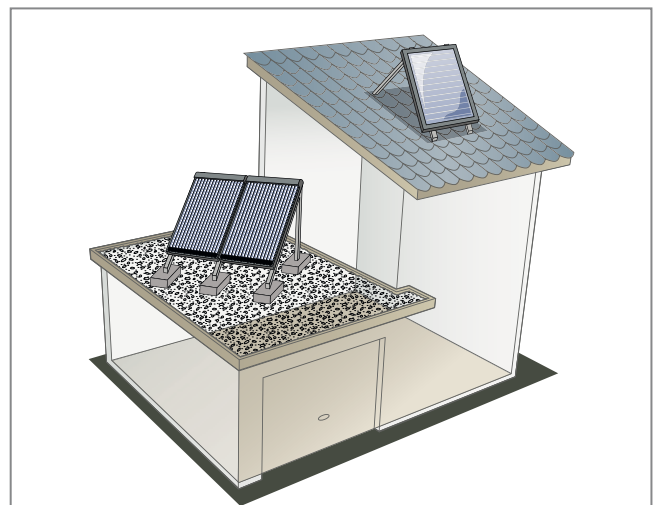
Abb 134: Freiaufstellung und aufgeständerte Aufdachmontage
