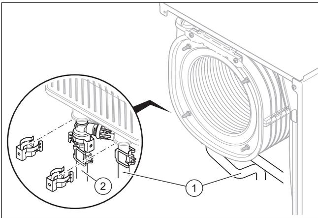
4. Entfernen Sie die Klammern am Vorlaufrohr (2) und am Rücklaufrohr (1).
