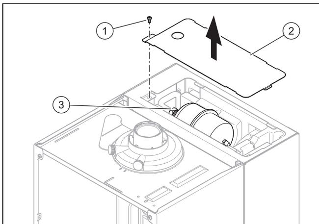
3. Drehen Sie die Schraube (1) an der Abdeckung (2) des Schichtladespeichers heraus.
