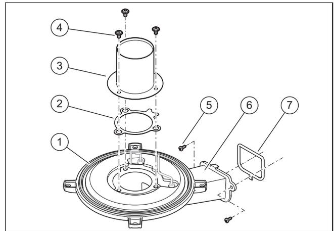
3. Schrauben Sie die zwei Schrauben (5) zwischen Brennerflansch (6) und Gebläse heraus.
