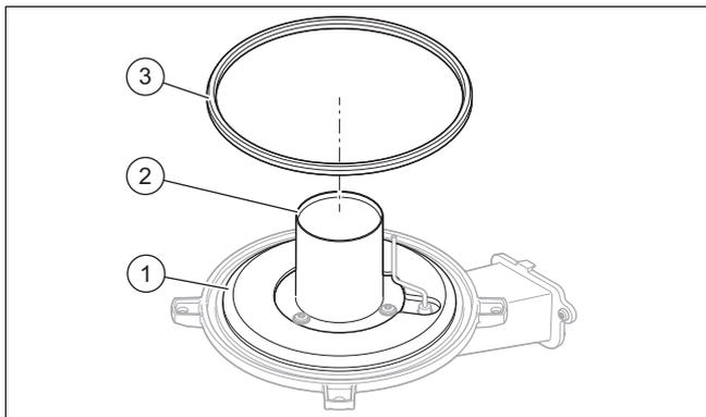
1. Prüfen Sie die Oberfläche des Brenners (2) auf Beschädigungen.
