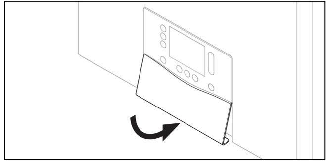
6. Montieren Sie ggf. die Frontblende unterhalb des Displays.
