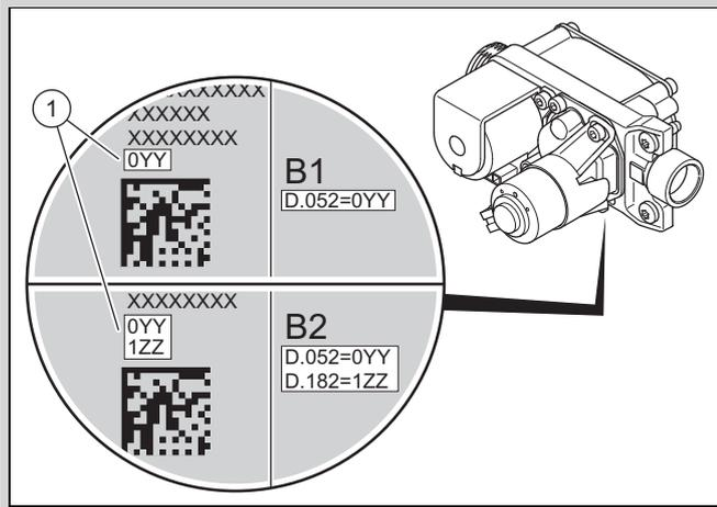
1. Lesen Sie den aufgedruckten Offset **(1)** von der Rückseite bzw. von der Unterseite der Gasarmatur ab. Verwenden Sie z. B. einen Spiegel. Im Ersatzteillfall lesen Sie den aufgedruckten Offset von der Vorderseite der Gasarmatur ab.
