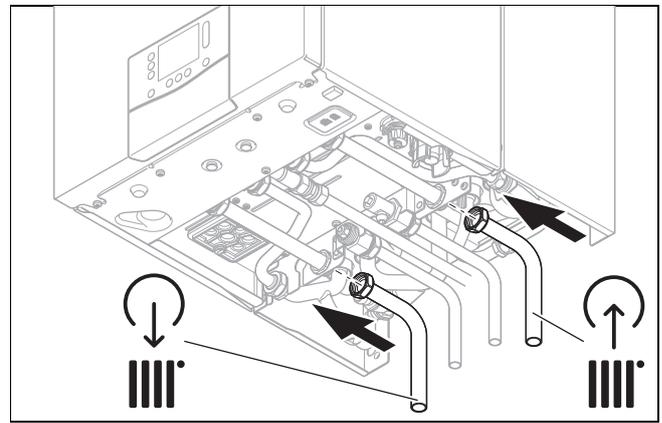
1. Installieren Sie das Rohr für den Heizungsvorlauf und den Heizungsrücklauf normgerecht.
