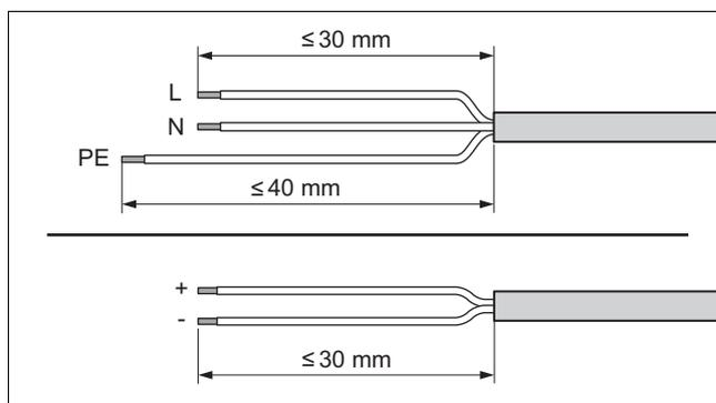
7. Entmanteln Sie die flexiblen Kabel, wie in der Abbildung dargestellt. Achten Sie dabei darauf, die Isolierungen der einzelnen Adern nicht zu beschädigen.
