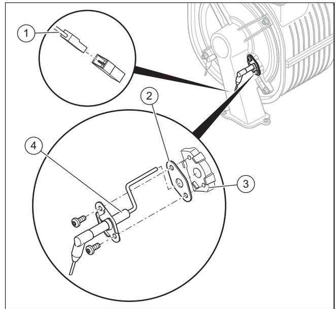
1. Ziehen Sie den Stecker (1) des Kabels der Regelungselektrode ab.
