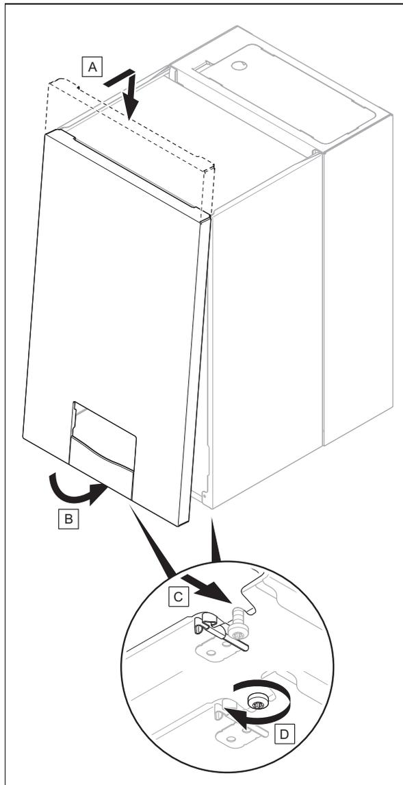
2. Schrauben Sie die zwei Schrauben an der linken und rechten Unterseite des Produkts fest.
