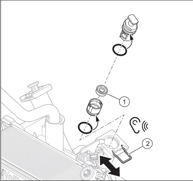
4. Ziehen Sie die Klammer (2) heraus in die Wartungsposition. Die Klammer ist gegen Herausfallen gesichert.
