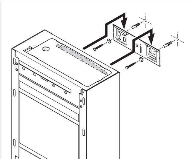
3. Hängen Sie den Schichtladespeicher des Produkts auf den Gerätehalter.
