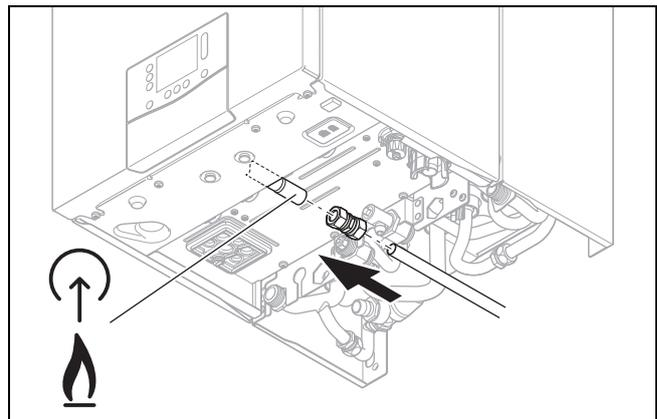
1. Installieren Sie das Gasrohr an den Gasanschluss spannungsfrei.
