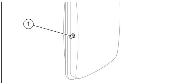
2. Prüfen Sie den Vordruck des Ausdehnungsgefäßes am Ventil (1) des Ausdehnungsgefäßes.
