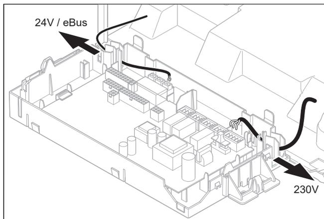
6. Verlegen Sie die Anschlusskabel der anzuschließenden Komponenten ordnungsgemäß im Schaltkasten.
