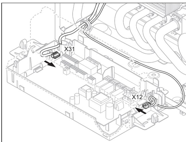
8. Stecken Sie den Stecker X12 des Pumpenkabels an Steckplatz X12 (rechte Seite der Leiterplatte).
