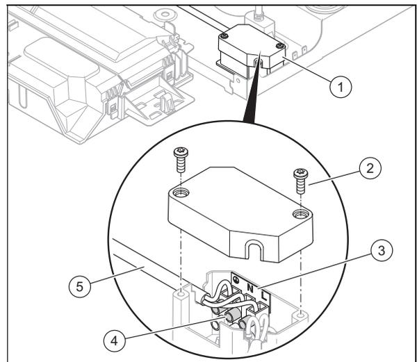
Schrauben Sie die zwei Schrauben (2) vom Gerätehauptschalter (1) heraus.
