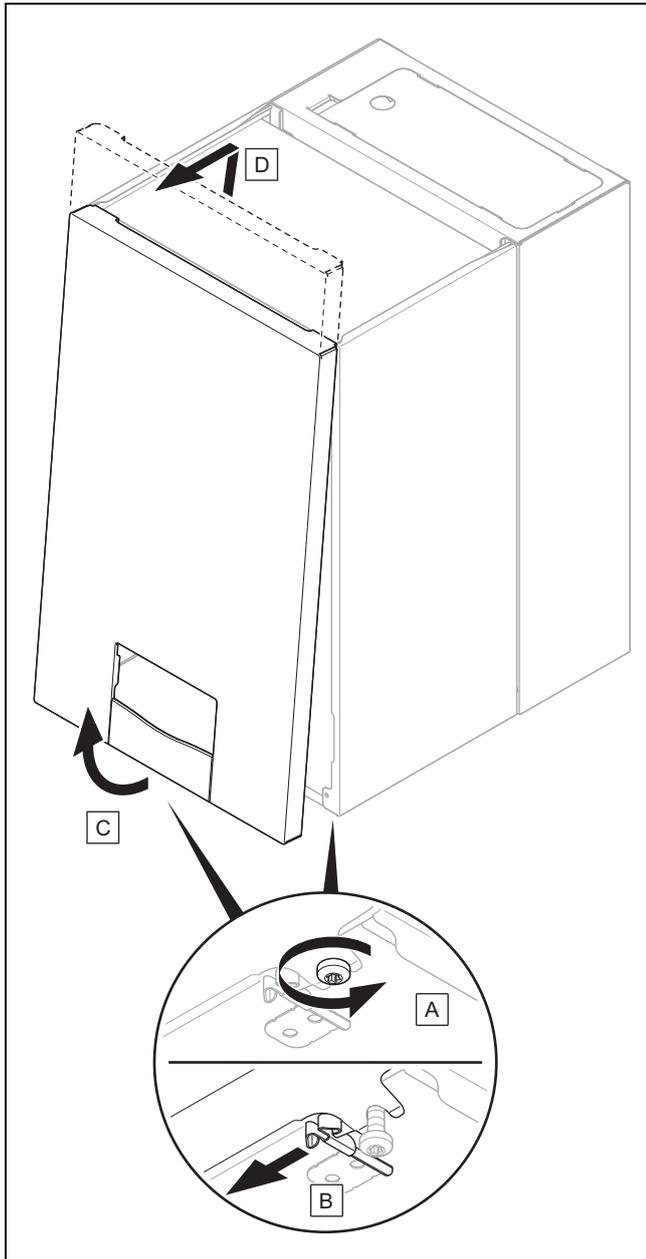
1. Lösen Sie die zwei Schrauben an der linken und rechten Unterseite des Produkts, ohne die Schrauben komplett herauszudrehen.
