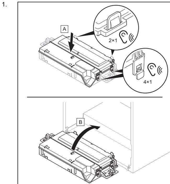
2. Achten Sie darauf, dass die Halter auf der rechten und linken Seite des Schaltkastens korrekt montiert sind.
