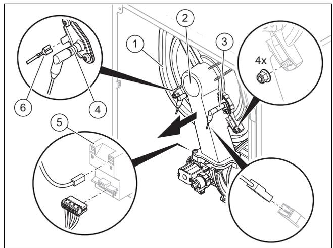
9. Ziehen Sie das Erdungskabel (6) von der Zündelektrode (4), die zwei Stecker vom Zündtransformator (5) und den Stecker des Kabels der Regelungselektrode (3) ab.
