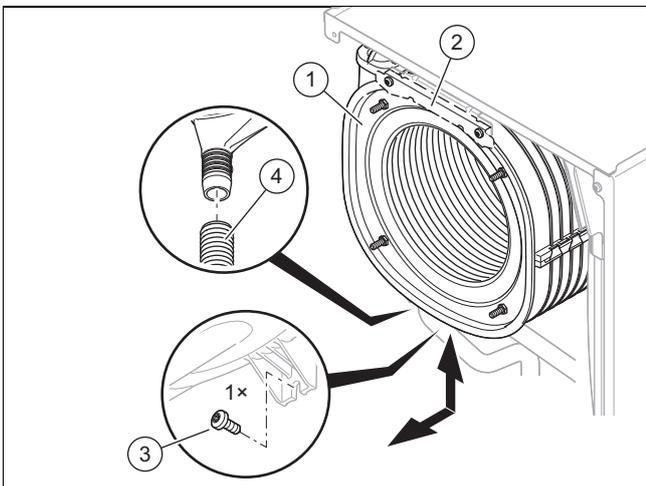
6. Ziehen Sie den Kondensatablaufschlauch (4) vom Wärmetauscher (1) ab.
