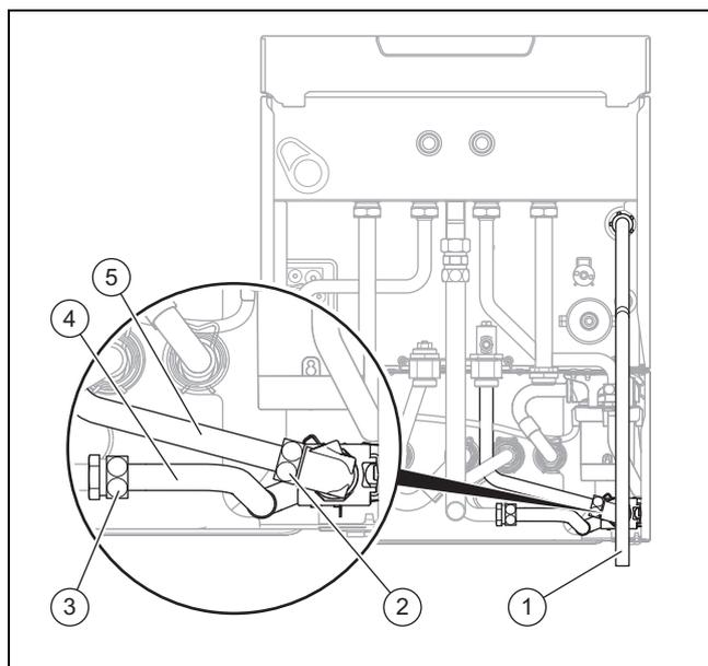
2. Nehmen Sie das Ablaufrohr (1) vom Sicherheitsventil des Wärmeerzeugers ab.
