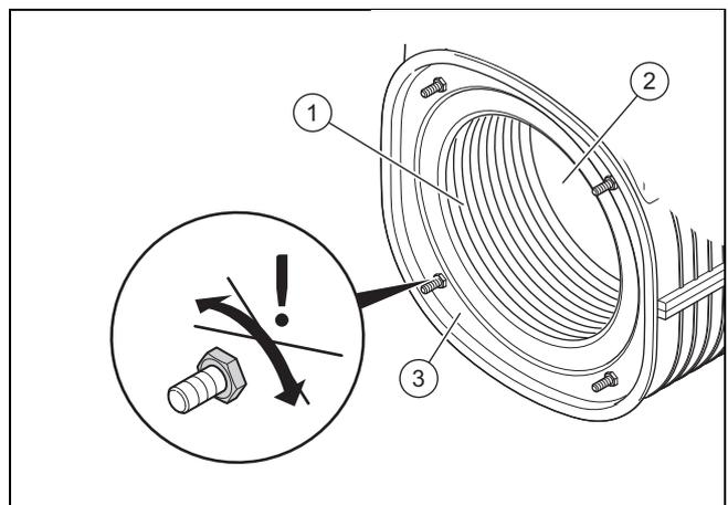
1. Reinigen Sie die Heizspirale (1) des Wärmetauschers (3) mit Wasser oder falls erforderlich mit Essig (bis max. 5 % Säure).
