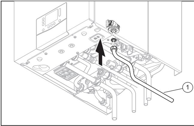
1. Installieren Sie das Ablaufrohr (1) für das Sicherheitsventil so, dass es beim Abnehmen und Aufsetzen des Siphon-Unterteils nicht stört.
