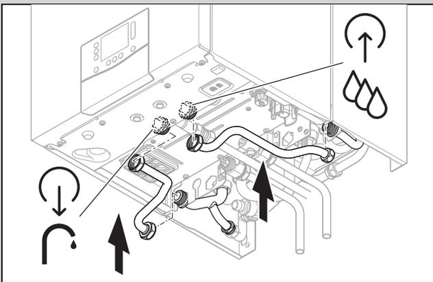
1. Installieren Sie die Rohre für Kalt-/Warmwasser normgerecht.
