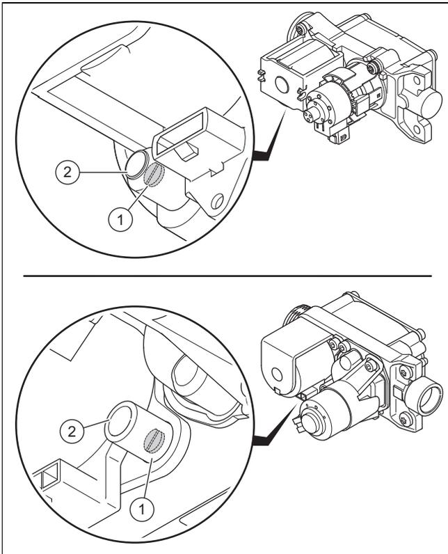
3. Lösen Sie die Prüfschraube (1).
