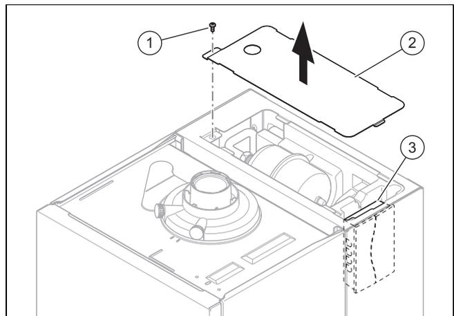
2. Drehen Sie die Schraube **(1)** an der Abdeckung des Schichtladespeichers heraus und nehmen Sie die Abdeckung **(2)** ab.
