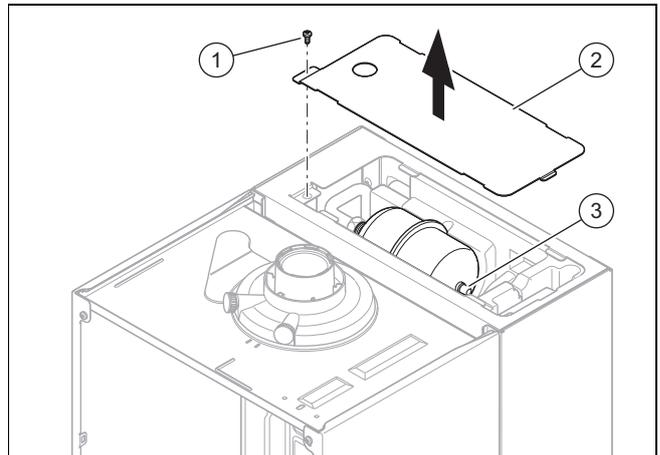
4. Drehen Sie die Schraube (1) an der Abdeckung (2) des Schichtladespeichers heraus.
