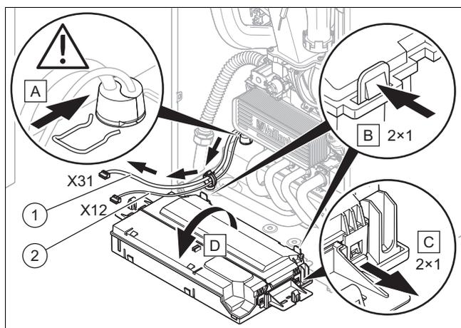
6. Führen Sie das Pumpenkabel **(2)** mit dem Stecker X12 außerhalb des Schaltkastens entlang.
