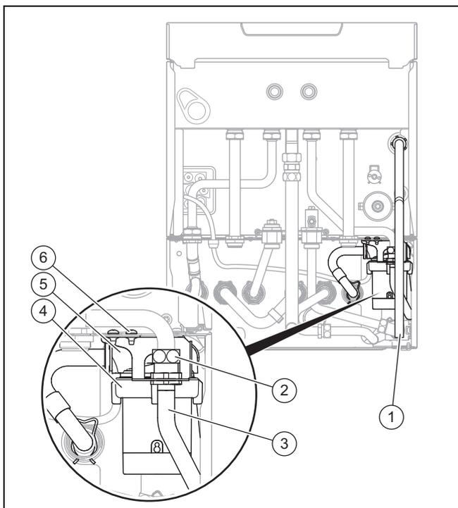
2. Nehmen Sie das Ablaufrohr (1) vom Sicherheitsventil des Wärmeerzeugers ab.
