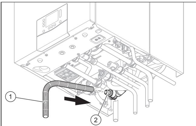
1. Stecken Sie den Flexschlauch (1) auf das Sicherheitsventil (2).
