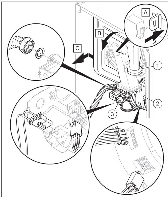
5. Ziehen Sie das Luftansaugrohr (1) aus dem oberen Halter heraus und nehmen Sie das Luftansaugrohr vom Ansaugstutzen ab, wie in der Abbildung dargestellt.
