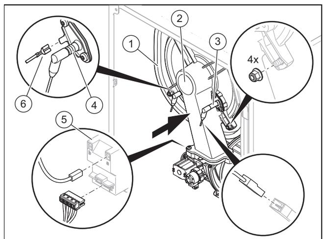
1. Stecken Sie das Thermo-Kompaktmodul auf den Wärmetauscher (1).
