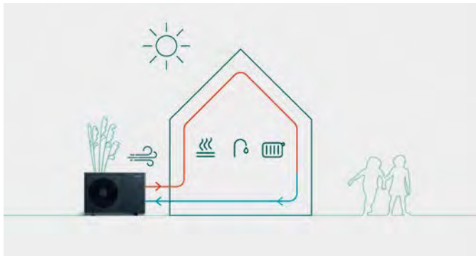
Außen aufgestellte Wärmepumpe
