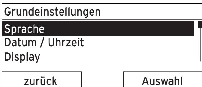
5. Drehen Sie den Drehknopf, bis der Listeneintrag **Display** markiert ist.
