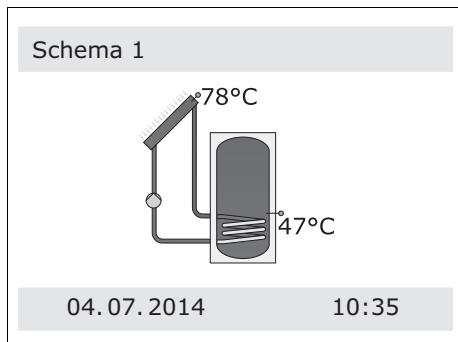
In der Grundanzeige sehen Sie immer ein Schema, dass der Fachhandwerker passend zu Ihrer Hausinstallation ausgewählt hat. Einige Bauteile der Anlage werden besonders hervorgehoben; z.B. eine Pumpe blinkt, wenn sie in Betrieb ist.
