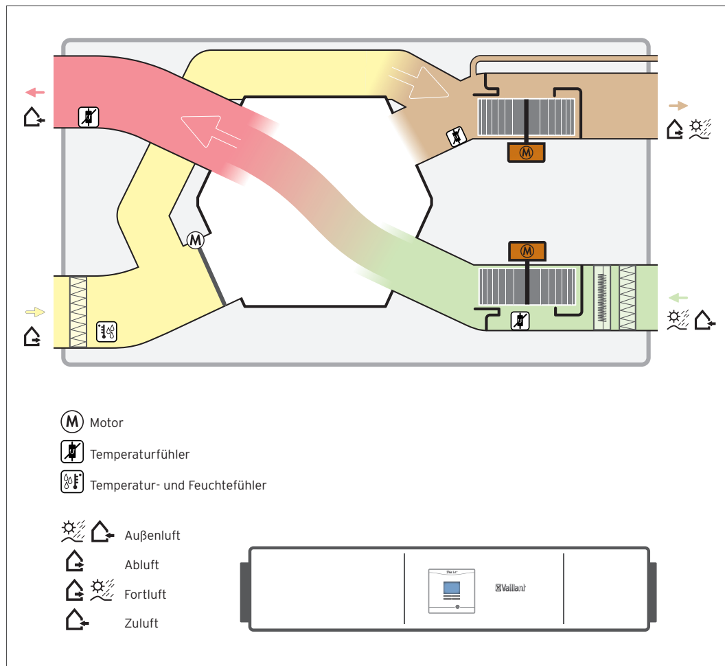
Abb 15: Funktionsschema recoVAIR VAR .../4 (Decken- und Wandgerät, Mittelstellung)
