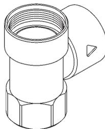
**Achtung!** Nach dem Einbau ist eine Funktionsüberprüfung vorzunehmen. Während der Beheizung muß aus Sicherheitsgründen Wasser aus der Abblaseleitung austreten! Nicht verschließen!
