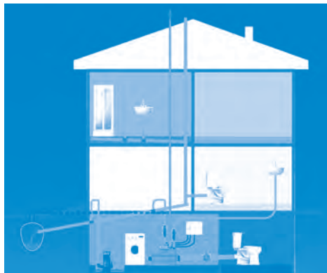
图1：潜水泵安装示意图：
