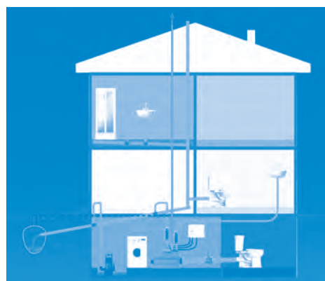
Figur 1: Eksempel på installation med dykpumpe:
