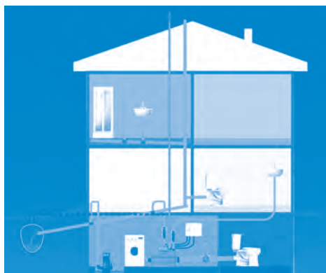
图1：潜水泵安装示意图：
