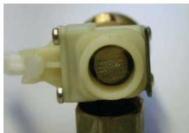
Siebeinsatz im Zulauf des Ventils eingesetzt
