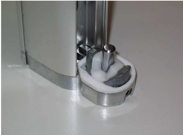
1) Hubmechanismus in „alter“ Ausführung
