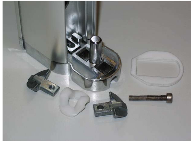
2) Teile des „alten“ Hubmechanismus demontieren
