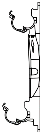
2. Verteilerstämme einlegen, am Lagering ausrichten
