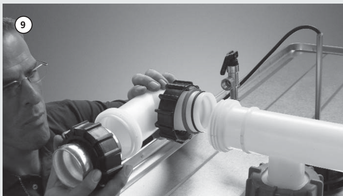
Nur bei einreihiger Aufstellung! Winkel-Verteilerrohr und Füllanschluss montieren, O-Ringe einfetten. Only with single-row installation! Install angled manifold and fill connection, lubricate O-rings. Uniquement pour une installation en une série ! Monter le tuyau distributeur coudé et le raccord de remplissage ; graisser les joints toriques. Alleen bij opstelling in één rij! Hoek-verdelerbuis en vul aansluiting monteren, O-ringen invetten.
