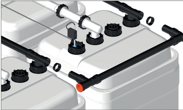
5. Entlüftungsleitung mit Anschlagdichtung LORO-X DN40 an die T-Entlüftungsstücke der Tankreihen anbringen.
