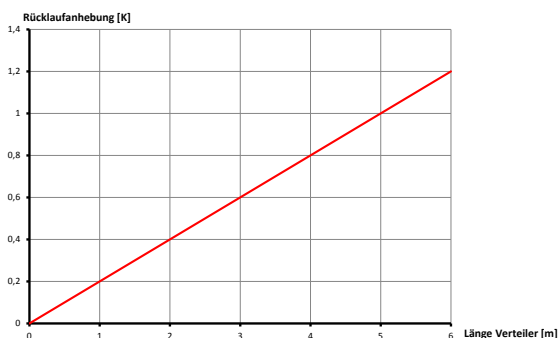
Wärmeübergang zwischen Vor- und Rücklaufkammer
