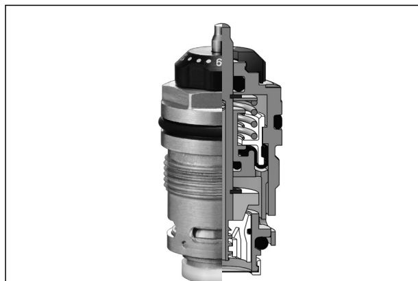
Vereinfachte Darstellung des Ventileinsatzes mit „Q-Tech“
