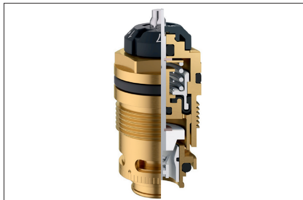
Vereinfachte Darstellung des Ventileinsatzes „QA“
