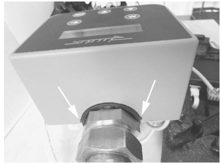
Afb. 10: Klik de achterwand van de elektronicabehuizing in
