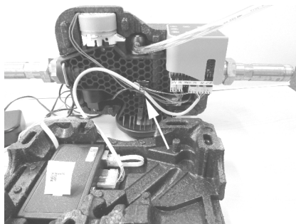
Fig. 9: Enfoncer le câble de connexion dans l'attache- câbles
