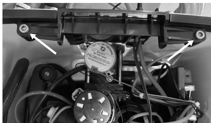
Abb. 13: Schrauben des schwarzen Einsatzes lösen
