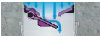
Abb. D-2: Klappenöffnung in Ablaufrichtung
