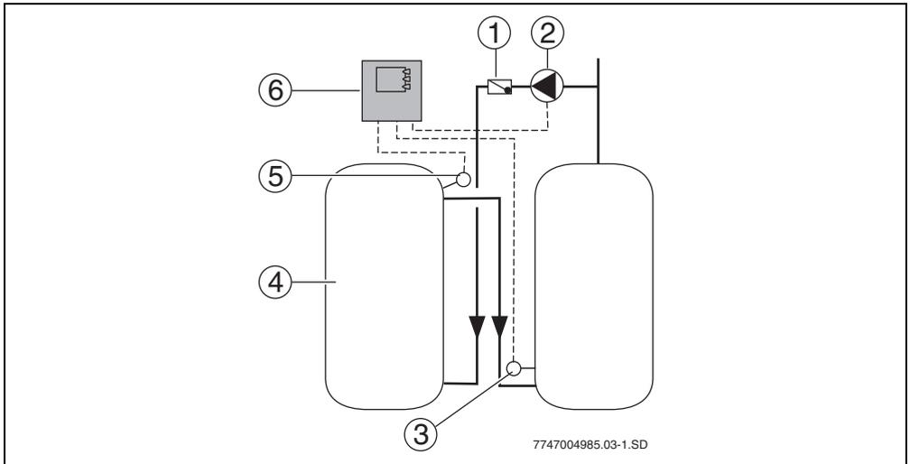
Bild 4 Umschichtfunktion
