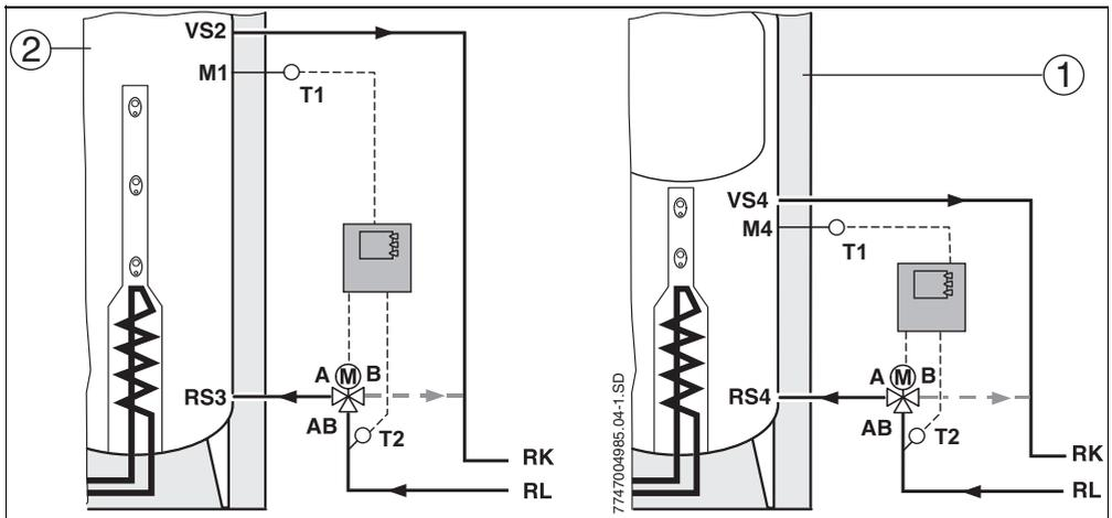
Bild 6 Rücklaufanhebung bei Pufferspeicher (links) und Kombispeicher (rechts)
