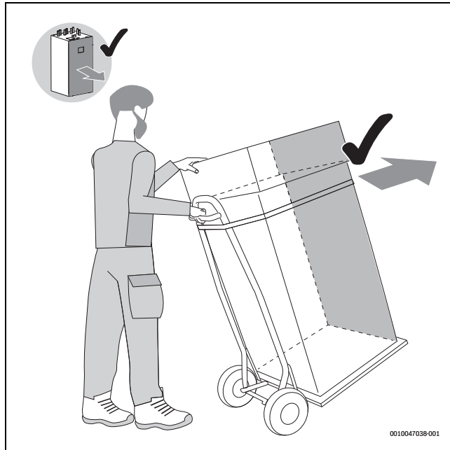
Bild 9 Inneneinheit mit einer Sackkarre transportieren
