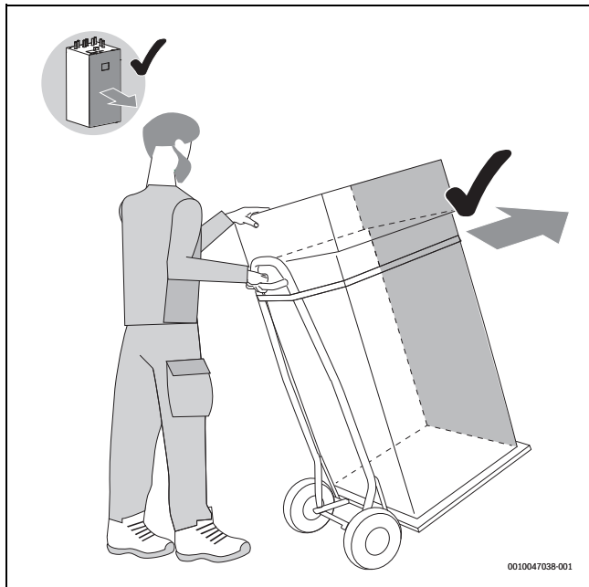
Bild 9 Inneneinheit mit einer Sackkarre transportieren
