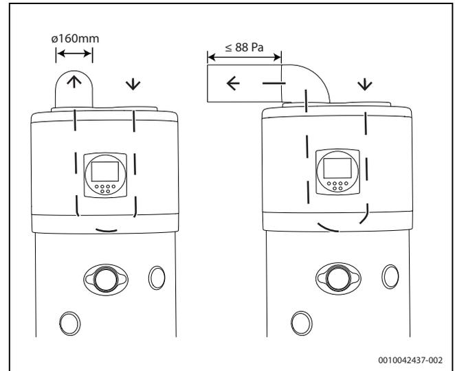
Bild 10 Einfache Luftleitung
