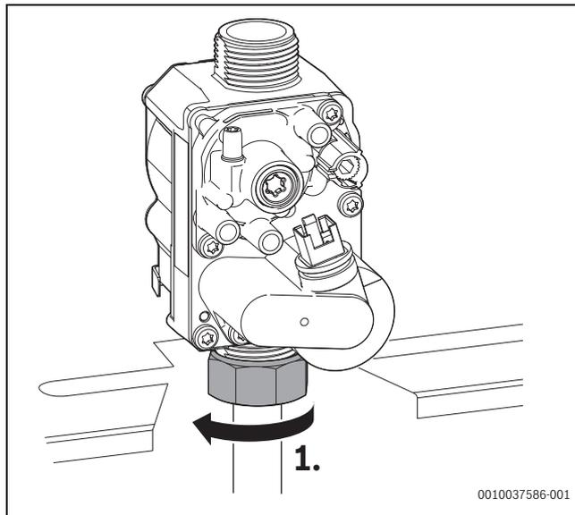
Bild 138 Überwurfmutter lösen
