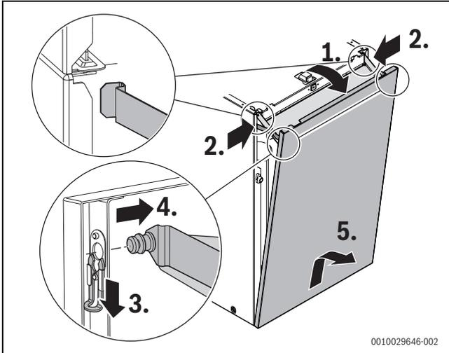
Bild 150 Vorderteil der Speicherverkleidung abnehmen und sicher abstellen
