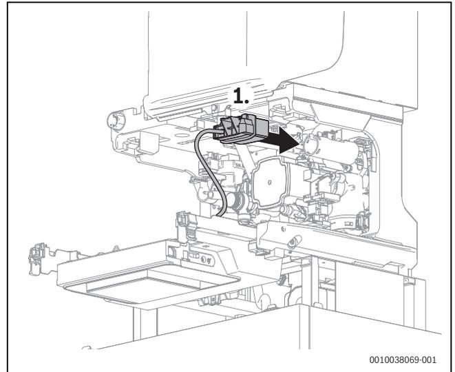
Bild 65 Funkmodul-Halter auf die Rückseite des Geräts führen
