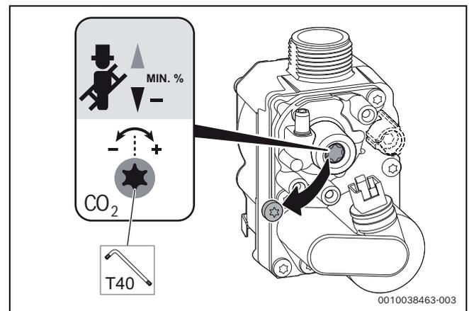
Bild 105 CO<sub>2</sub>/O<sub>2</sub>-Gehalt bei minimaler Nennwärmeleistung einstellen
