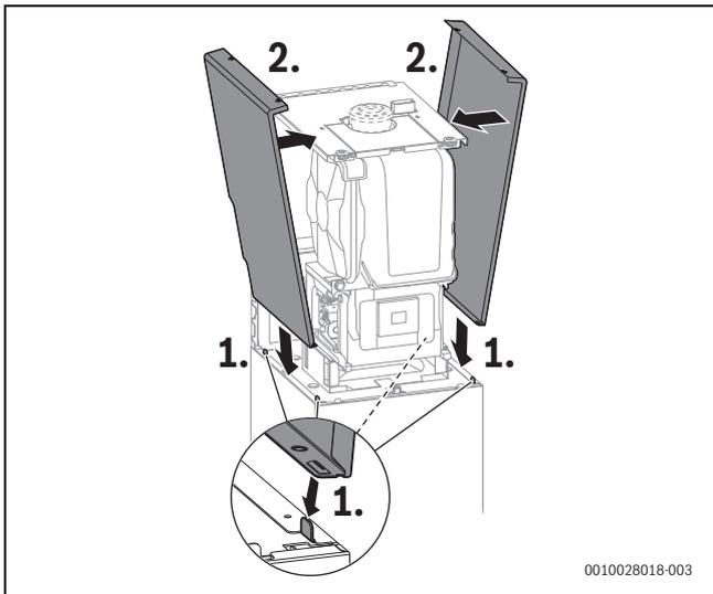
Bild 88 Seitenteile der Geräteverkleidung einsetzen
