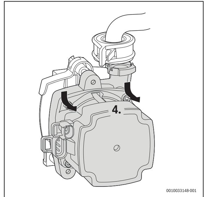
Bild 134 Heizungspumpe abnehmen
