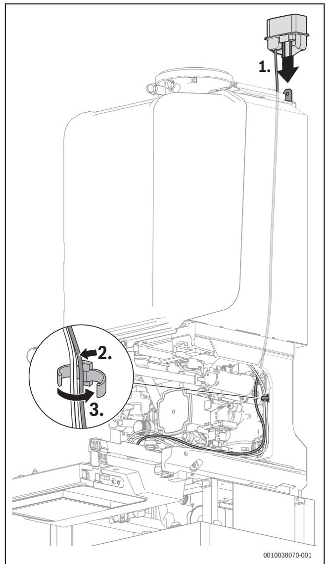
Bild 66 Funkmodul-Halter in den Steckplatz einsetzen und Kabel im Kabelhalter befestigen
