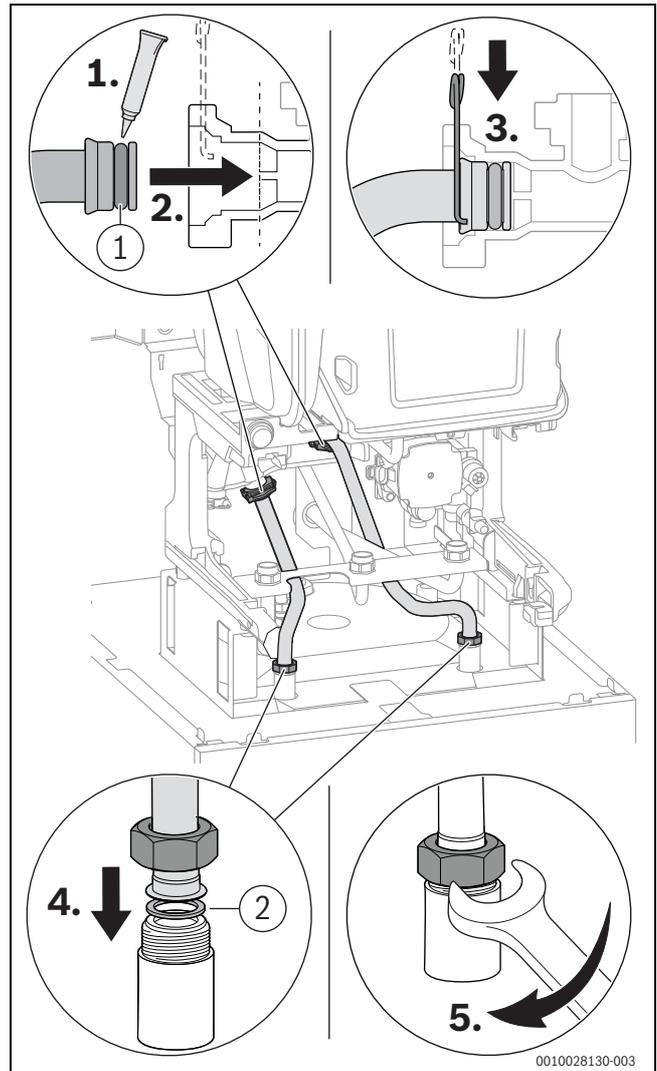
Bild 62 Vorlaufrohr und Rücklaufrohr zum Rohrwendelspeicher anschließen
