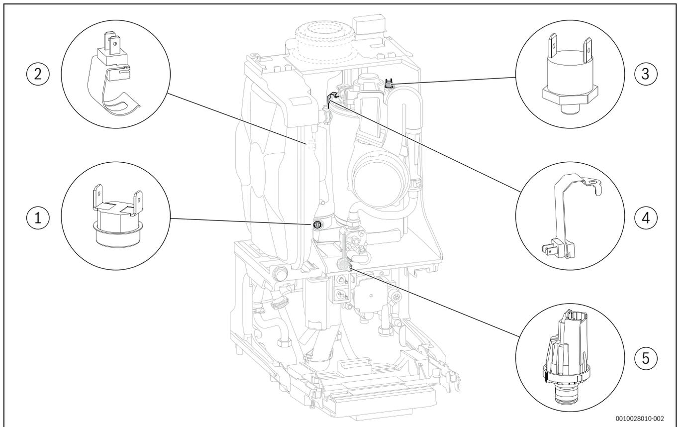
Bild 5 Übersicht der Fühler im Gerät
