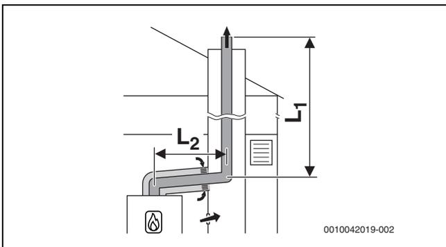
Bild 35 Starre Abgasführung im Schacht nach B<sub>53P</sub>/B<sub>53S</sub> mit raumluftabhängiger Luftzufuhr über die konzentrische Luft-Abgas-Führung im Aufstellraum
