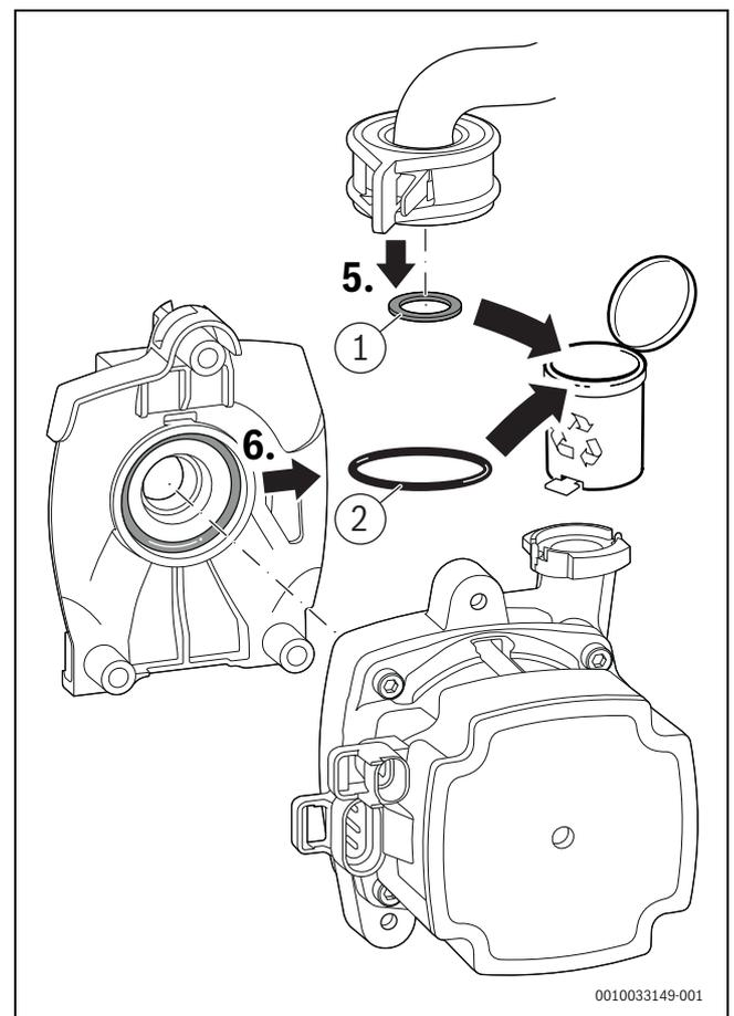
Bild 135 Dichtungen entsorgen
