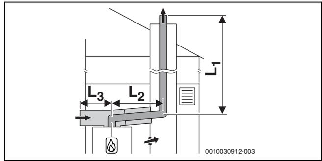
Bild 29 Starre Abgasführung nach C<sub>53x</sub> im Schacht und Luft-Abgas-Führung mit separater Luftzufuhr und konzentrischer Abgasableitung im Aufstellraum
