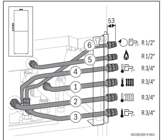
Bild 53 Zubehör CS 10 auf der linken Seite montiert
