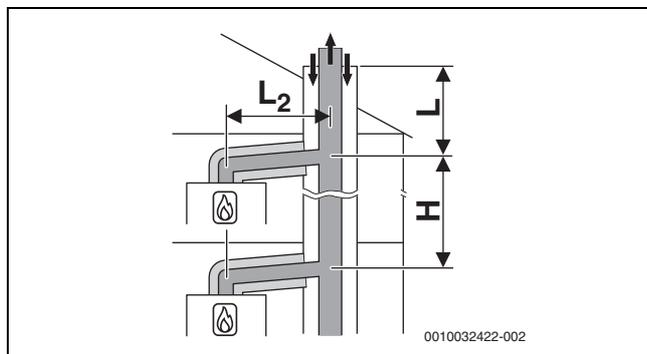
Bild 41 Mehrfachbelegung nach C<sub>(14)3x</sub> mit kollektiver starrer Abgasführung und konzentrischer Luft-Abgas-Führung im Aufstellraum
