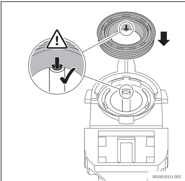
Bild 146 Neue Dichtung am Kondensatsiphon ausrichten
