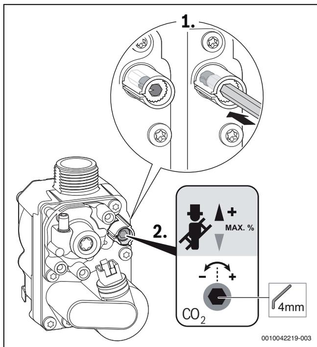
Bild 104 CO<sub>2</sub>/O<sub>2</sub>-Gehalt bei maximaler Nennwärmeleistung einstellen
