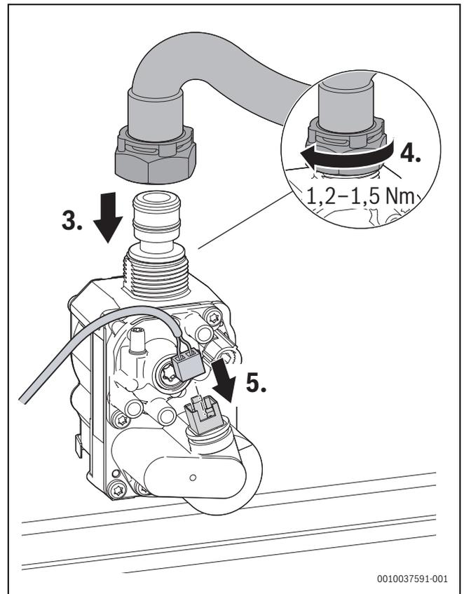
Bild 143 Gasschlauch und Stecker anschließen – Anzugsdrehmoment beachten
