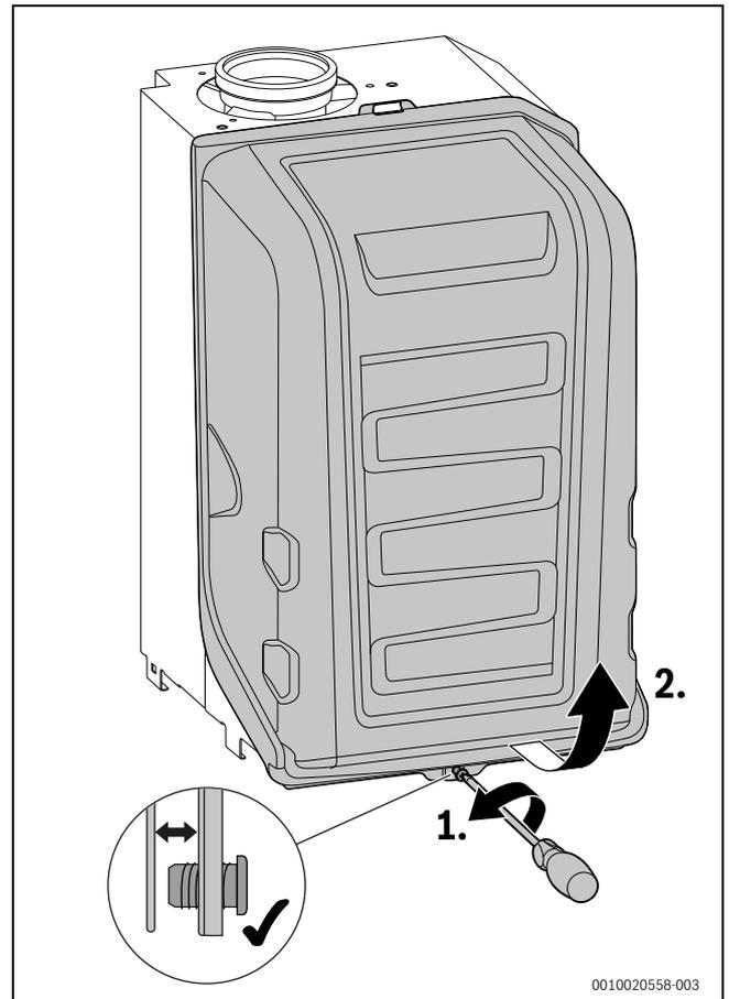
Bild 101 Brennerhaube abnehmen
