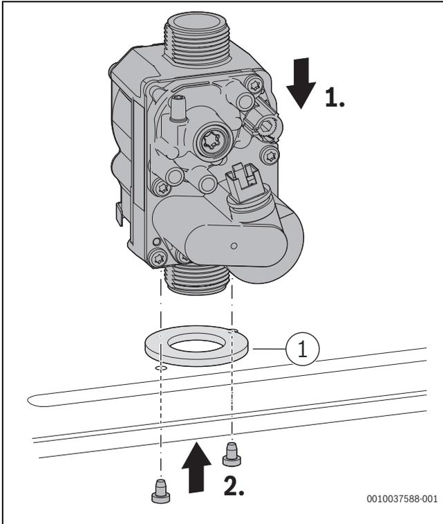
Bild 140 Gasarmatur einbauen
