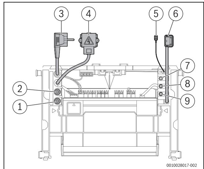
Bild 82 Lieferzustand des Steuergeräts mit angeschlossenen Komponenten
