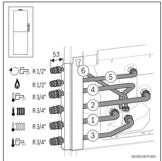
Bild 54 Zubehör CS 10 auf der rechten Seite montiert
