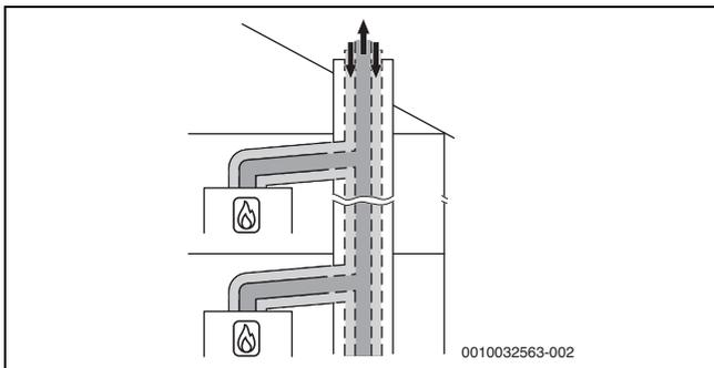
Bild 38 Mehrfachbelegung nach C<sub>(10)3x</sub> mit konzentrischer Luft-Abgas-Führung im Aufstellraum
