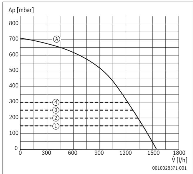
Bild 153 Pumpenkennfelder und Pumpenkennlinie (17/24 kW)
