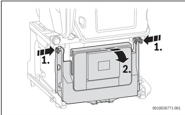
Bild 60 Steuergerät herunterklappen
