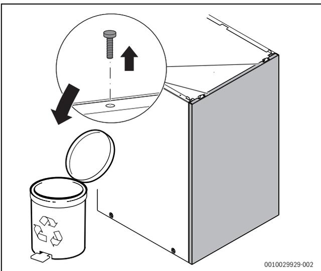
Bild 52 Transportsicherung am Vorderteil der Speicherverkleidung entfernen
