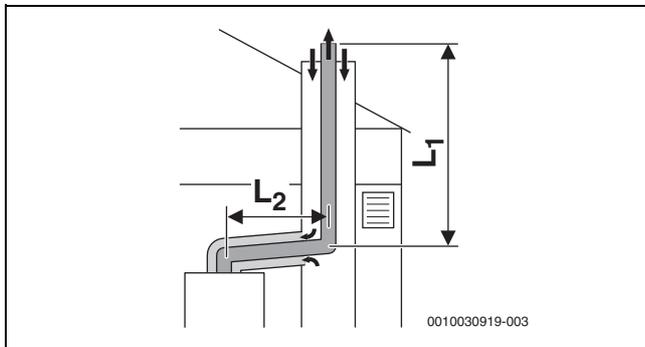
Bild 32 Starre Abgasführung nach C<sub>93x</sub> im Schacht und konzentrische Luft-Abgas-Führung im Aufstellraum
