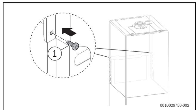
Bild 92 Seitenteile der Geräteverkleidung auf der linken und rechten Seite festschrauben
