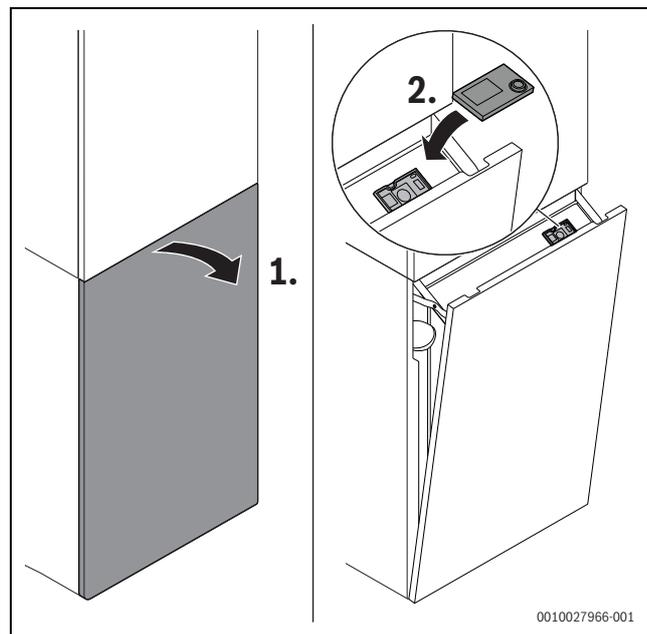
Bild 74 Bedieneinheit Logamatic RC310 einsetzen
