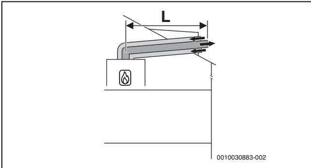
Bild 25 Horizontale konzentrische Luft-Abgas-Führung nach C<sub>13x</sub> über das Dach
