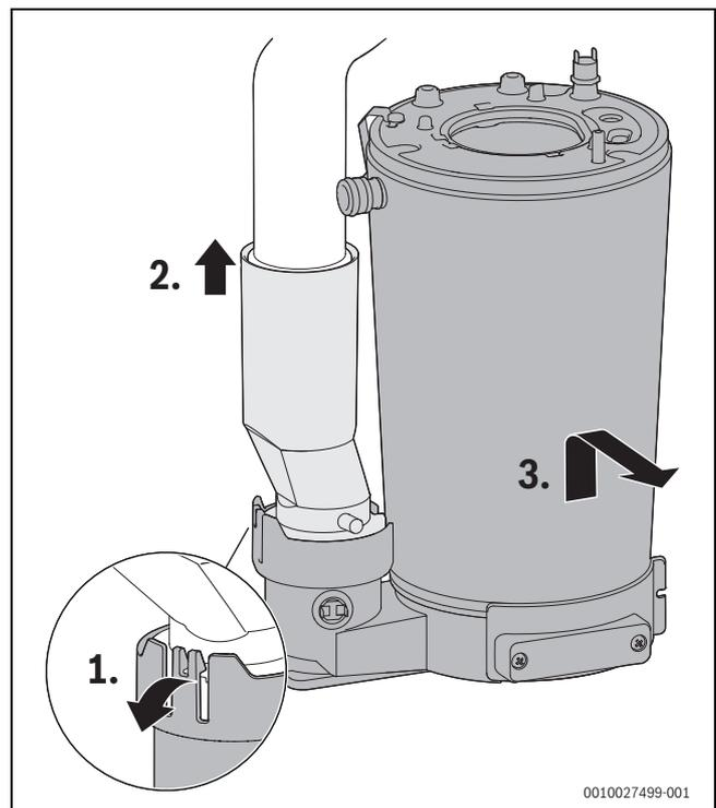
Bild 131 Wärmeblock ausbauen
