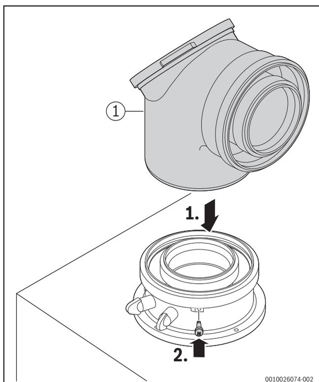
Bild 73 Abgaszubehör einsetzen und mit Schraube sichern
