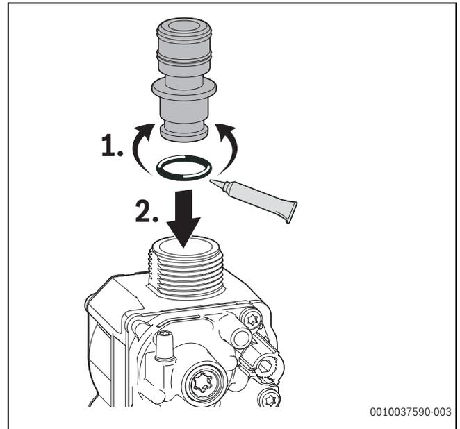
Bild 142 Gasdüse einsetzen
