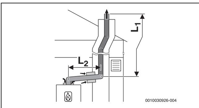
Bild 36 Flexible Abgasführung im Schacht nach B<sub>53P</sub> mit raumluftabhängiger Luftzufuhr am Gerät und konzentrischem Verbindungsstück zwischen Aufstellraum und Schacht
