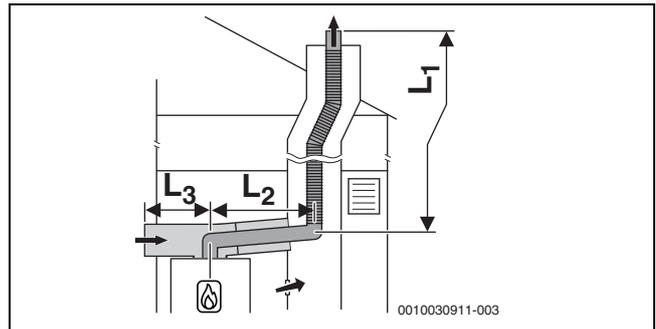
Bild 30 Flexible Abgasführung nach C<sub>53x</sub> im Schacht und Luft-Abgas-Führung mit separater Luftzufuhr und konzentrischer Abgasableitung im Aufstellraum
