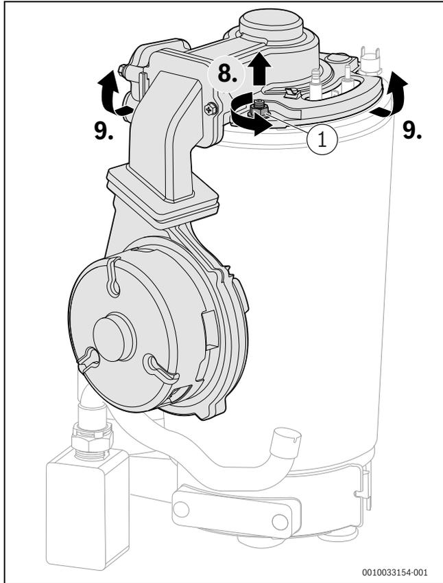
Bild 118 Brennerdeckel mit Gebläse und Mischeinrichtung abnehmen
