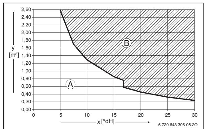
Bild 46 Anforderungen an Füll- und Ergänzungswasser Geräte < 50 kW
