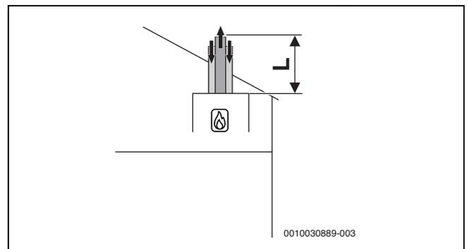
Bild 27 Vertikale konzentrische Luft-Abgas-Führung nach C<sub>33x</sub>
