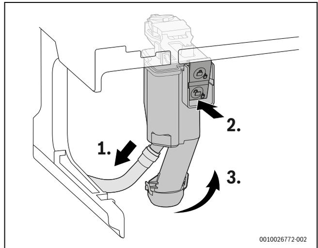
Bild 145 Kondensatsiphon ausbauen
