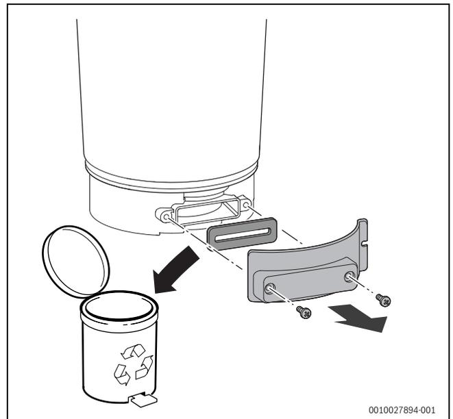
Bild 127 Prüfoffnung öffnen
