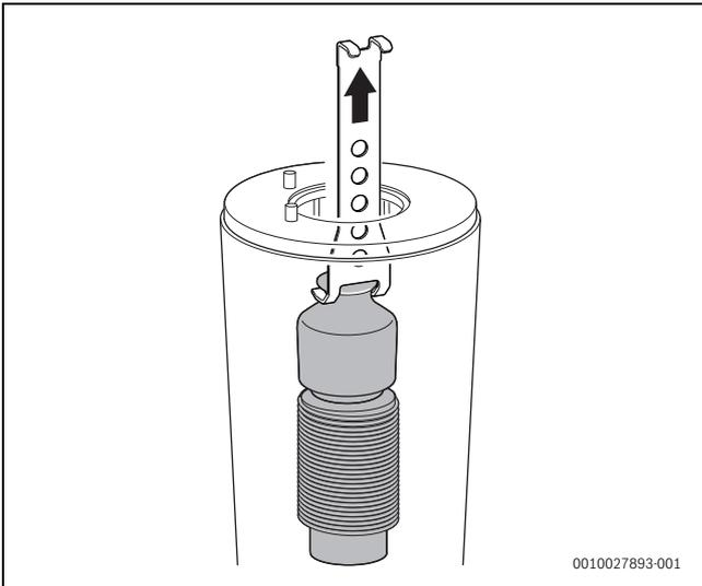
Bild 122 Oberen Verdrängungskörper herausnehmen
