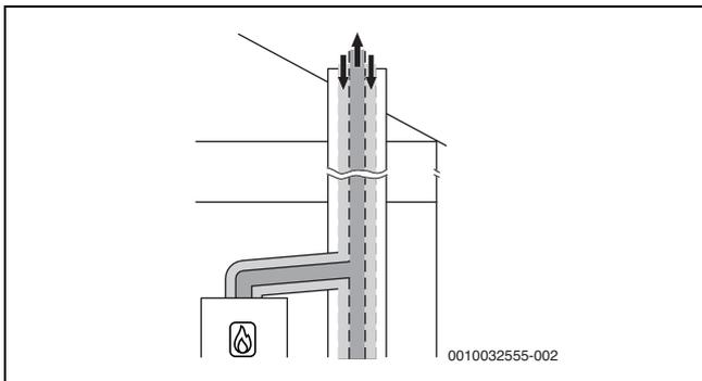
Bild 28 Konzentrische Luft-Abgas-Führung nach C<sub>43x</sub> im Aufstellraum
