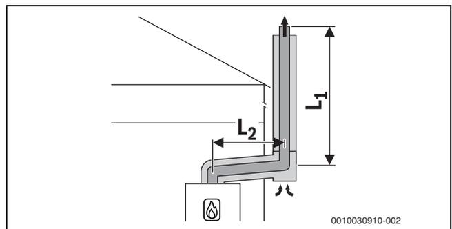
Bild 31 Konzentrische Luft-Abgas-Führung nach C<sub>53x</sub> an der Außenwand
