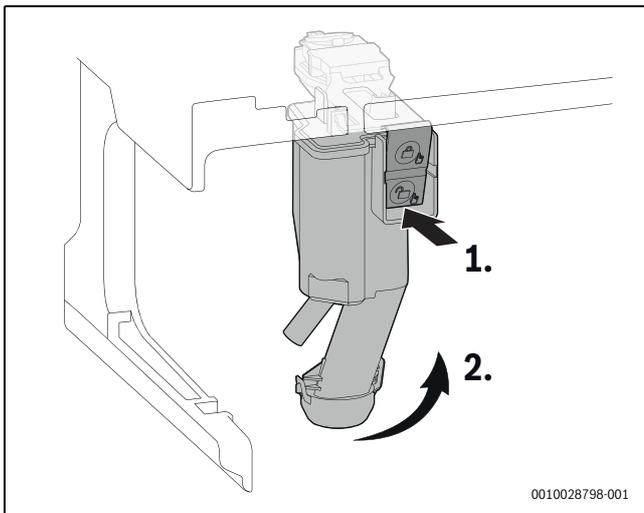
Bild 61 Kondensatsiphon herausnehmen
