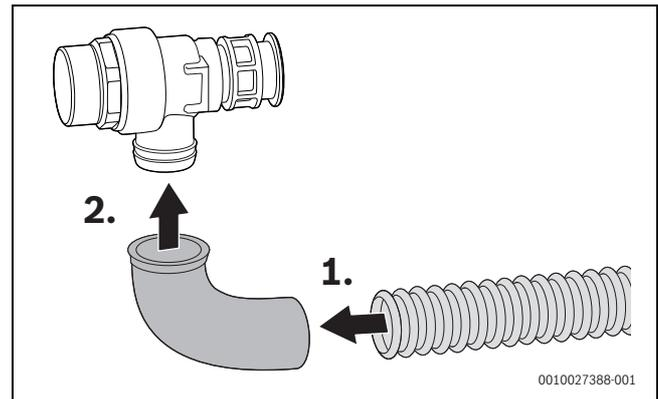
Bild 69 Schlauch am Sicherheitsventil anschließen
