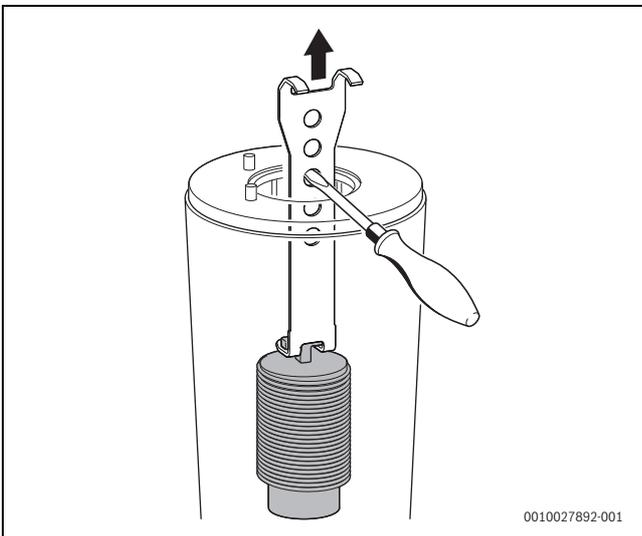
Bild 123 Unteren Verdrängungskörper herausnehmen
