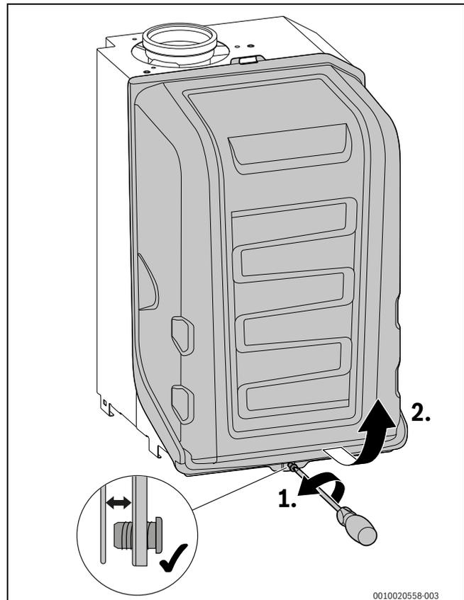
Bild 76 Brennerhaube abnehmen
