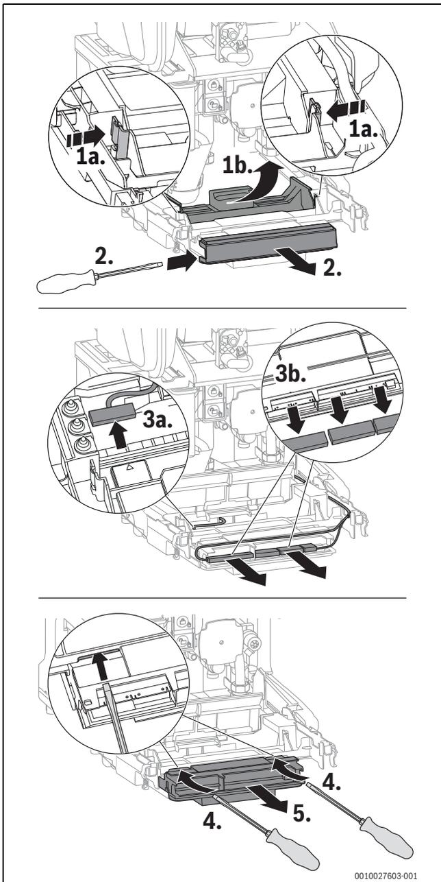
Bild 144 Steuergerät herausnehmen
