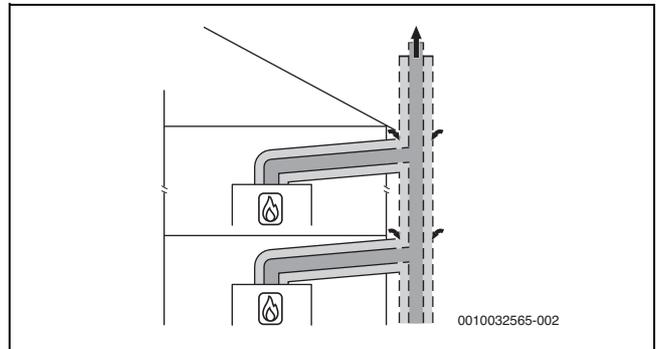
Bild 39 Mehrfachbelegung nach C<sub>(12)3x</sub> mit konzentrischer Luft-Abgas-Führung im Aufstellraum
