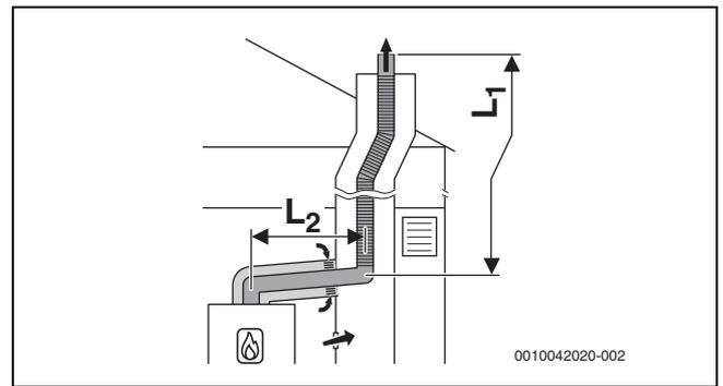
Bild 37 Flexible Abgasführung im Schacht nach B<sub>53P</sub>/B<sub>53S</sub> mit raumluftabhängiger Luftzufuhr über die konzentrische Luft-Abgas-Führung im Aufstellraum
