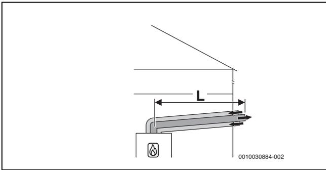
Bild 24 Horizontale konzentrische Luft-Abgas-Führung nach C<sub>13x</sub> durch die Außenwand
