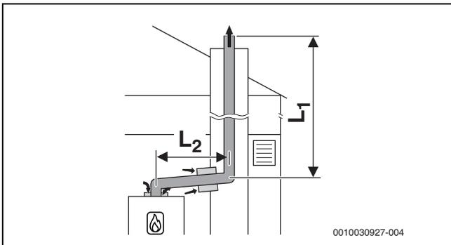
Bild 34 Starre Abgasführung im Schacht nach B<sub>53P</sub> mit raumluftabhängiger Luftzufuhr am Gerät und konzentrischem Verbindungsstück zwischen Aufstellraum und Schacht
