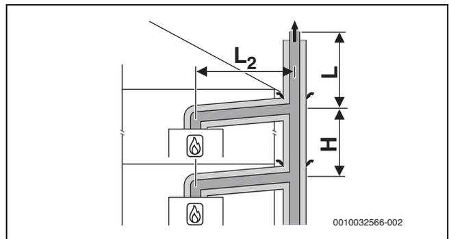
Bild 40 Mehrfachbelegung nach C<sub>(13)3x</sub> mit konzentrischer Luft-Abgas-Führung an der Außenwand und im Aufstellraum
