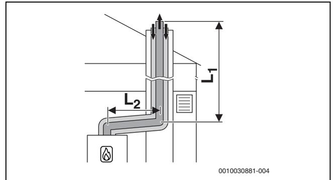
Bild 26 Konzentrische Luft-Abgas-Führung nach C<sub>33x</sub> im Schacht
