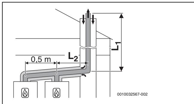
Bild 44 Kaskade mit 2 Geräten:
