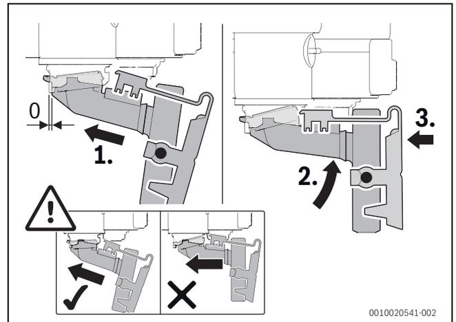
Bild 148 Kondensatsiphon einbauen
