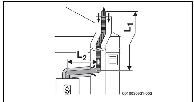
Bild 33 Flexible Abgasführung nach C<sub>93x</sub> im Schacht und konzentrische Luft-Abgas-Führung im Aufstellraum
