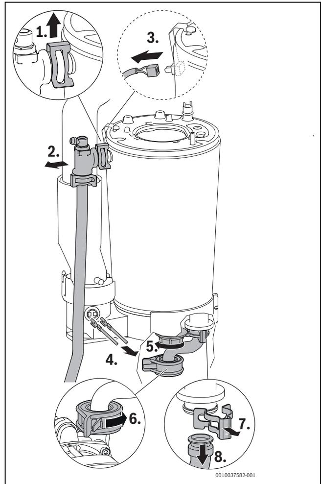
Bild 130 Vorlaufrohr lösen, Kabel abziehen und Rücklaufrohr lösen
