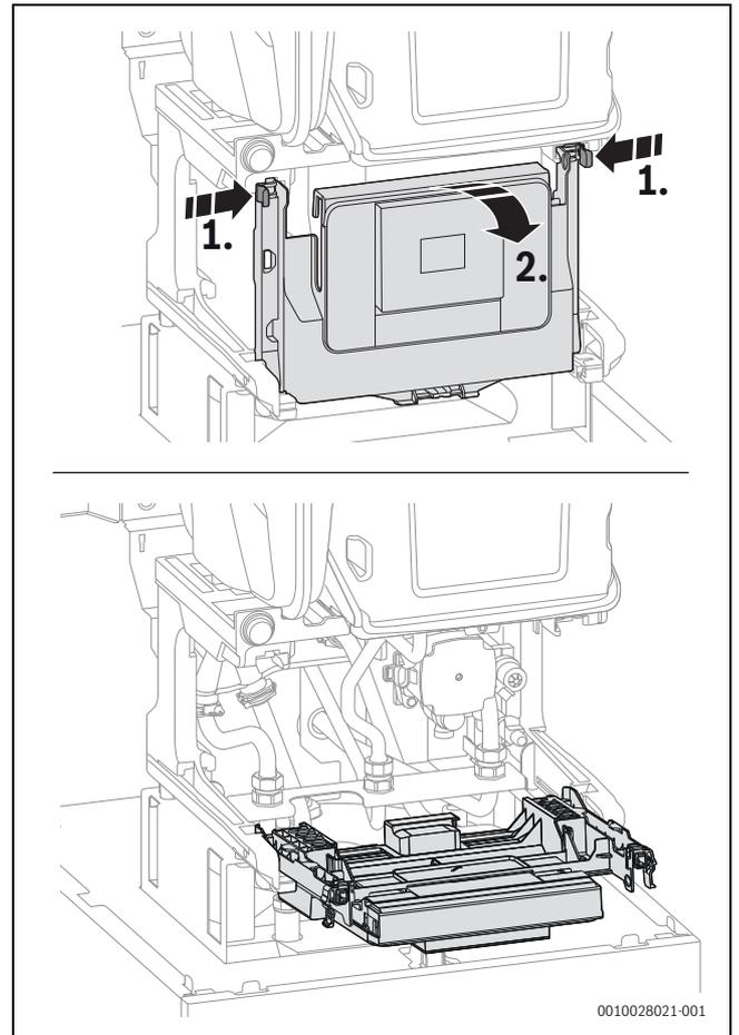
Bild 112 Steuergerät herunterklappen
